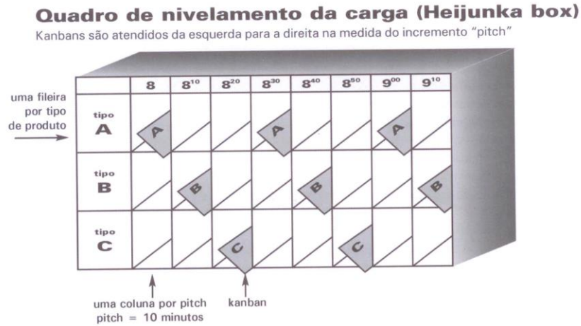
Figura 2.7 – Exemplo de heijunka box Fonte: Rother e Shook (2009)
