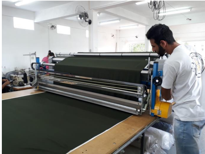
Figura 4.7 – Processo de enfiesto Fonte: Stock
