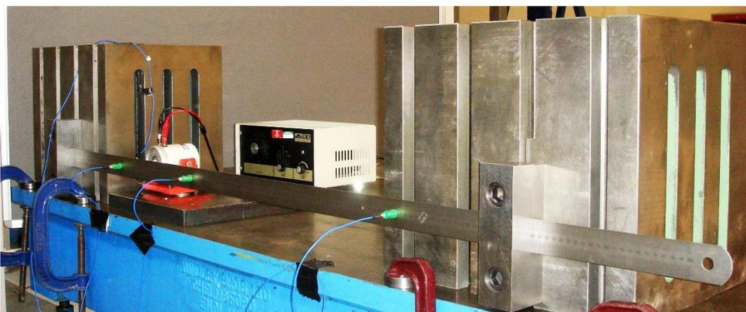
Figura 20: Visão geral do sistema de viga fixa-fixa. Fonte: (Adhikari, Friswell, & Lonkar, 2007b).
