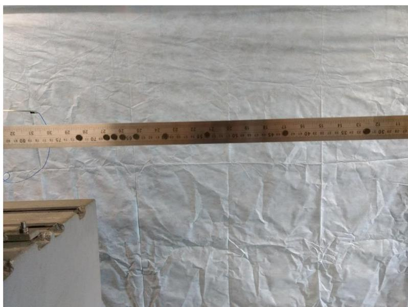
Figura 68: Massas posicionadas em localizações aleatórias da viga. Fonte: autor.
