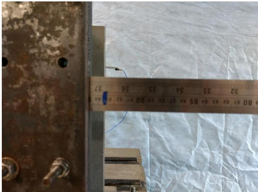
Figura 69: Marca feita na viga para excitação com o martelo de impacto. Fonte: autor.
