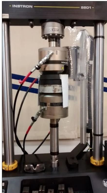
Figura 17: Equipamento utilizado para ensaio de compressão
