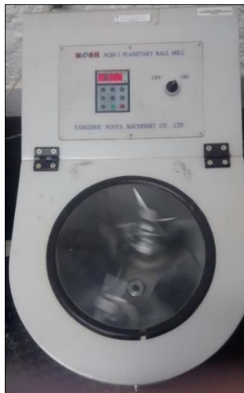
Figura 10: Moinho planetário de alta energia em funcionamento
