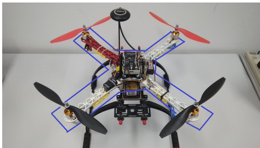
Figura A.2 – Frame de uma ARP Quadrotor (destaque em azul). Fonte: Produção do Autor.
