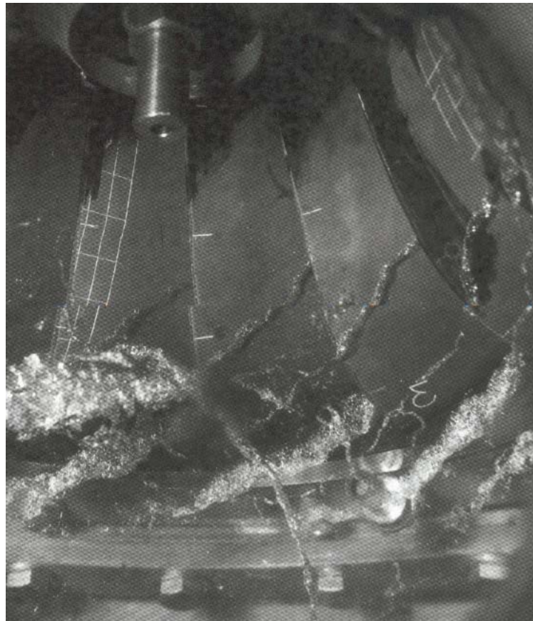
Figura 3.9 – Turbilhões livres em modelo reduzido de Itaipu [43].
