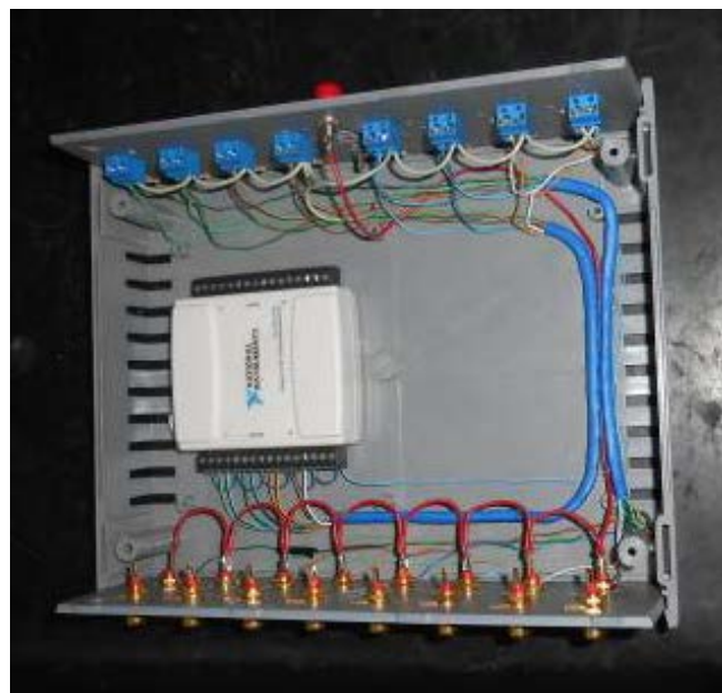
Figura 4.18 – Sistema de conversão construído.
