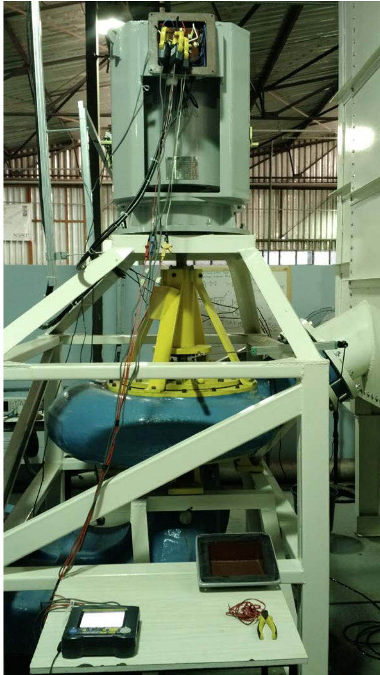
Figura 4.16 – Medição elétrica na saída do gerador.
