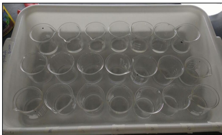
Figura 16 - Ensaio preliminar de toxicidade aguda com o efluente da nitrocelulose utilizando o organismo D. similis . Fonte: Própria.
