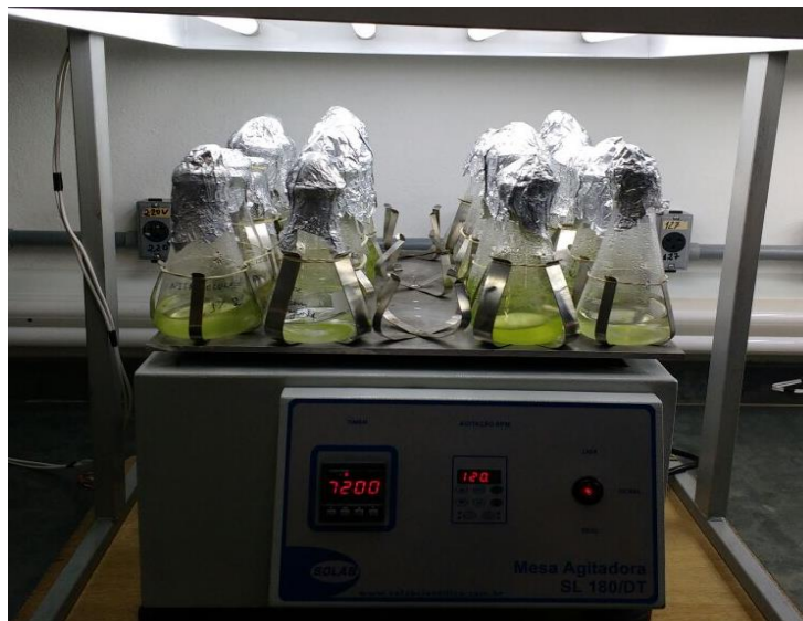
Figura 18 - Ensaio de toxicidade crônica utilizando o efluente da nitrocelulose com o inoculo celular de R. subcapitata , com temperatura, intensidade luminosa e agitação constantes. Fonte: própria.
