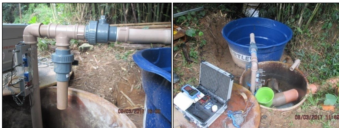
Figura 14 - Ponto de medição da vazão do efluente do trinitrotolueno, água amarela. Fonte: Própria.
