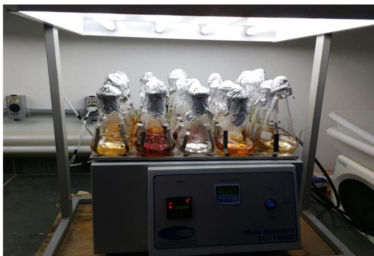
Figura 17 - Ensaio de toxicidade crônica utilizando o efluente água amarela com o inóculo celular de R. subcapitata , com temperatura, intensidade luminosa e agitação constantes. Fonte: própria.
