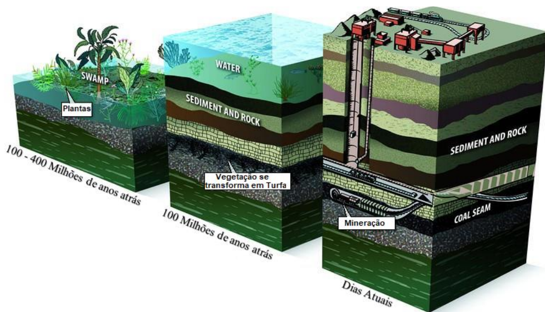
Figura 2.1 - Representação esquemática do processo evolutivo de origem das reservas de carvão mineral atualmente existentes.
