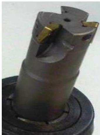
Figura 6.4 – Cabeçote com insertos para o fresamento de topo.
