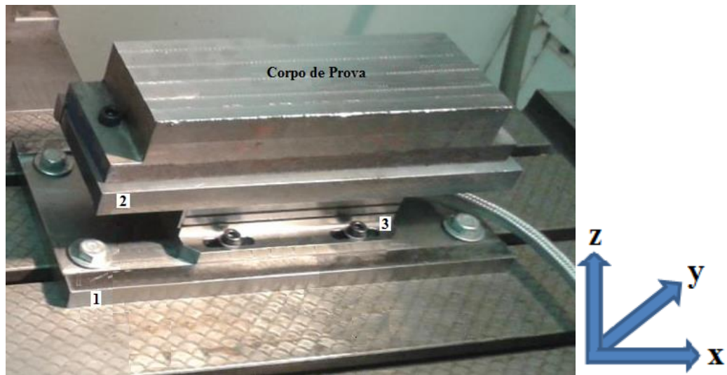
Figura 6.5 – Fixação do corpo de prova na máquina: 1) Dispositivo inferior; 2) Dispositivo superior; 3) Dinamômetro.
