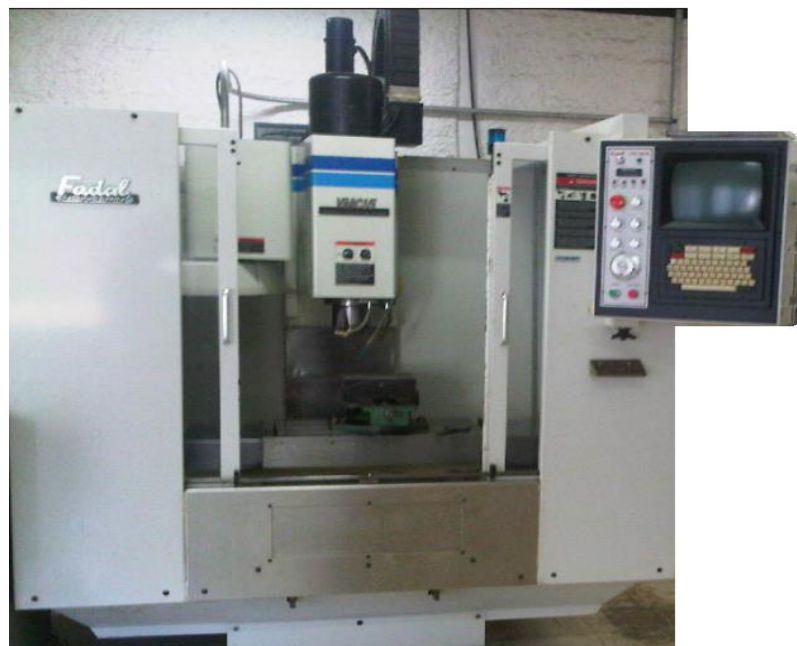
Figura 6.3 – Centro de usinagem fadal (UNIFEI).
