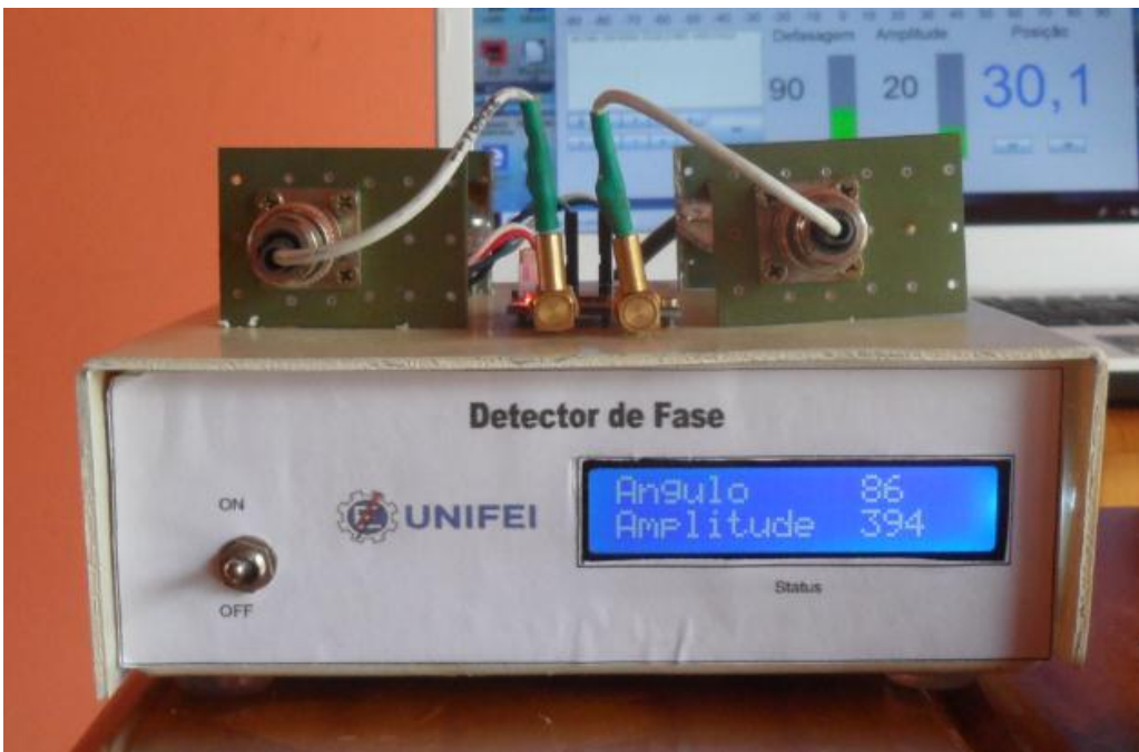
Fig. 7.11- Vista frontal do conjunto montado.
