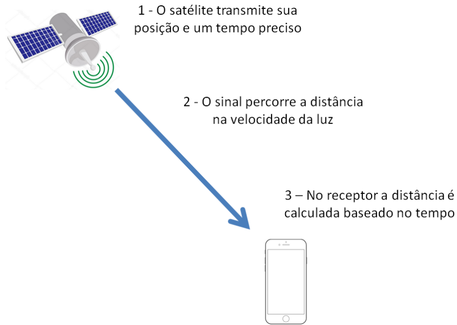
Fig. 4.7– Determinação da distância entre o satélite e a estação móvel no sistema GPS.
