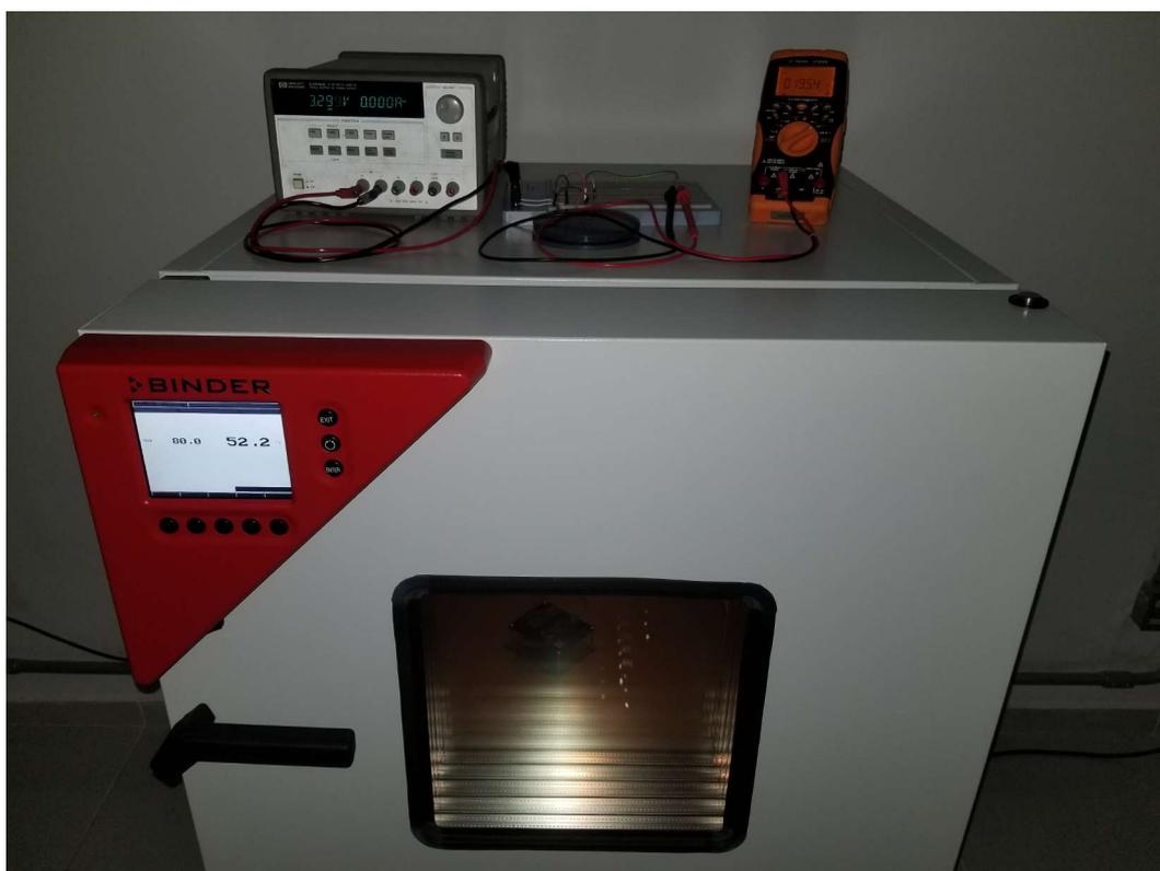
Figura 4.12 – Estação de medidas de temperatura no laboratório.
