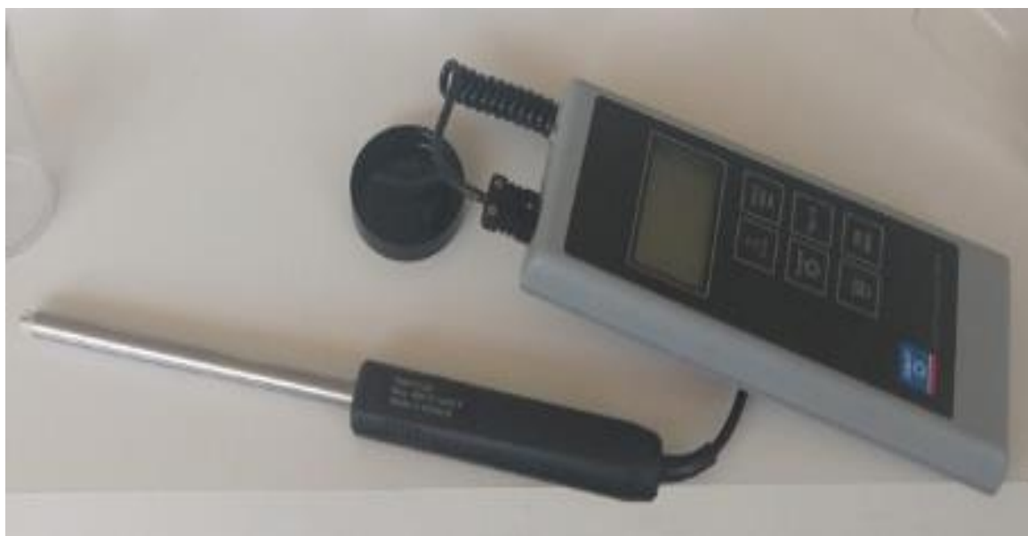
Figura 3.16 - Termômetro digital de contato SKF TMDT2.
