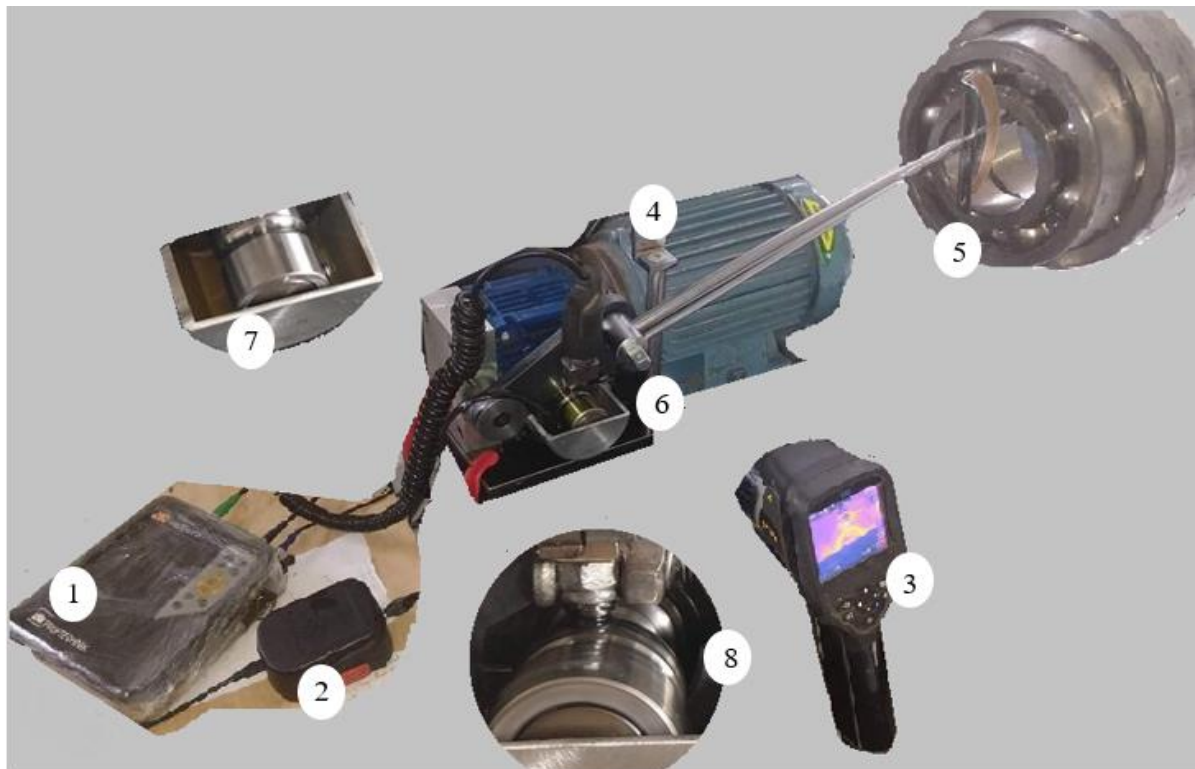
Figura 3.1 - Bancada de ensaios: 1-Coletor de vibrações Vibexpert II; 2-Sistema utilizado para monitorar temperatura do óleo; 3- Câmera Termográfica FLIR E40; 4- Motorreductor; 5- Carga; 6- Peças submetidas a desgaste e reservatório de óleo; 7- Zoom do reservatório de óleo e 8- Zoom da amostra submetida a desgaste.
