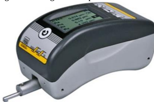
Figura 3.6: Rugosímetro portátil Surftest 201
