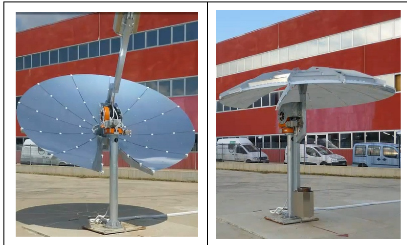
Figura 1.2 - Concentrador dish em operação (esquerda) e na posição stow (direita) Fonte: Adaptado de Innova (2017)
