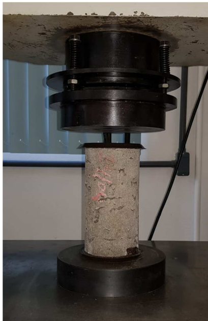
Figura 25 – Corpo de prova sendo posicionado para o ensaio de resistência à compressão. Fonte Autor
