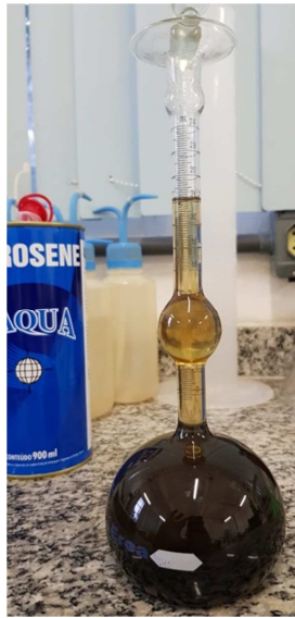
Figura 13 – Frasco utilizado para o cálculo da massa específica do Pó de pneu.
