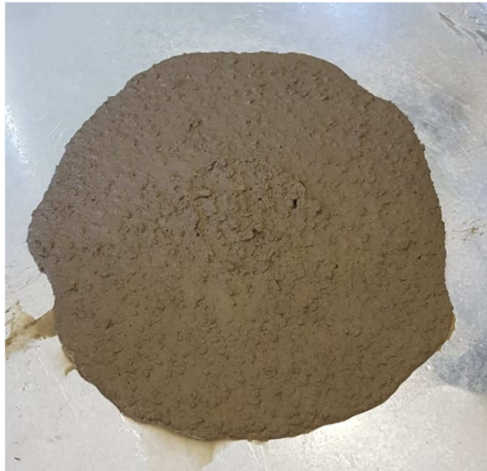
Figura 22 – Resultado do Slump Flow Test para a mistura com 10% de pó de pneu (48cm).
