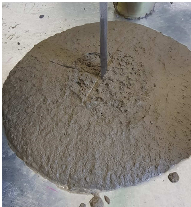
Figura 22 – Resultado do Slump Flow Test para a mistura com 10% de pó de pneu (48cm).
