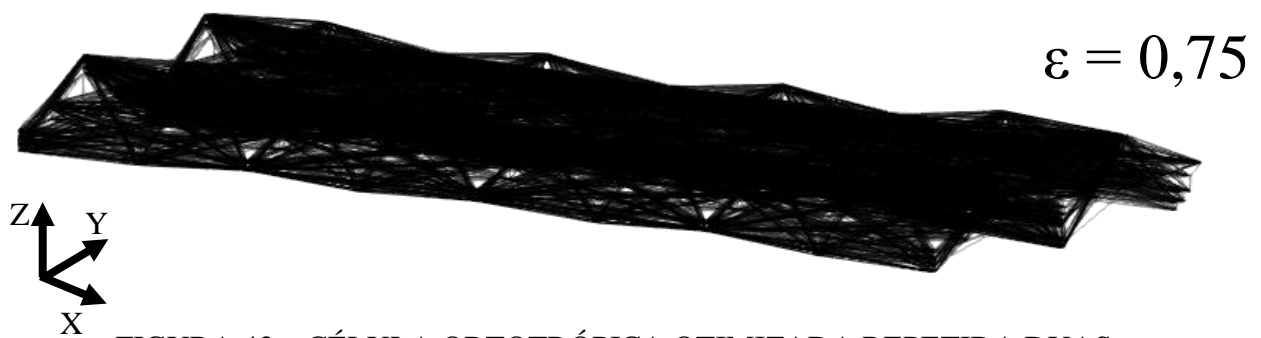
FIGURA 43 – CÉLULA ORTOTRÓPICA OTIMIZADA REPETIDA DUAS VEZES EM CADA DIREÇÃO COM DEFORMAÇÃO ESPECÍFICA DE 0,75
