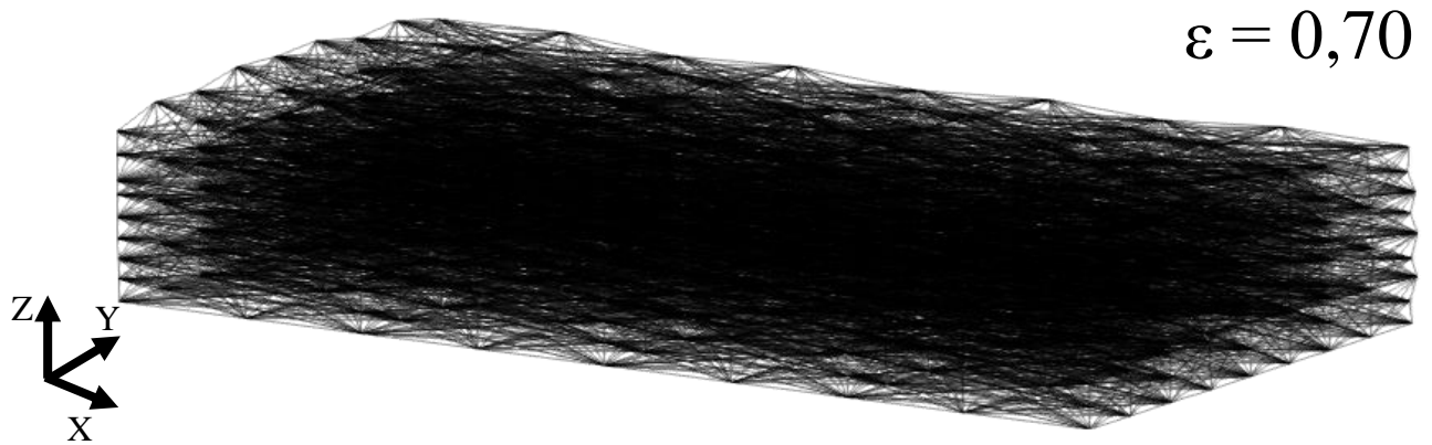
FIGURA 42 – CÉLULA ORTOTRÓPICA OTIMIZADA REPETIDA DUAS VEZES EM CADA DIREÇÃO COM DEFORMAÇÃO ESPECÍFICA DE 0,7
