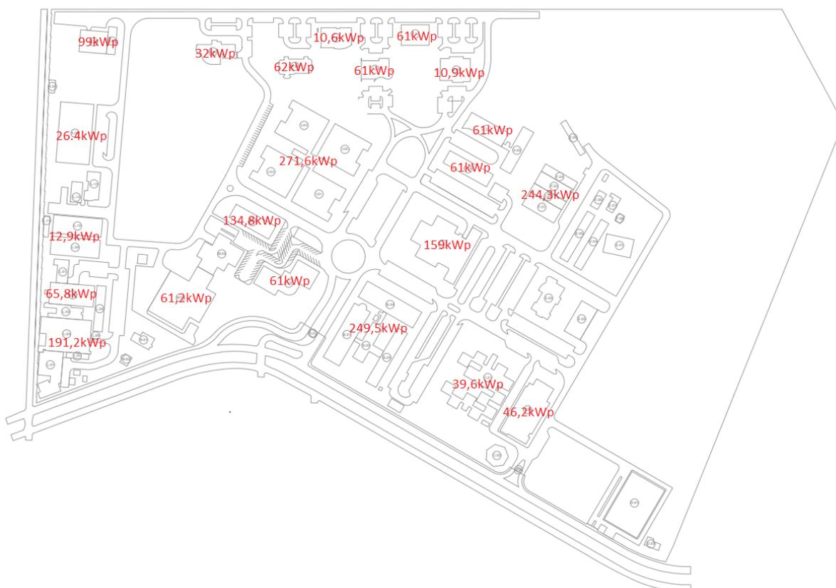
Fig. 3. 12– Sistema PV descentralizado na UNIFEI – Itajubá.
