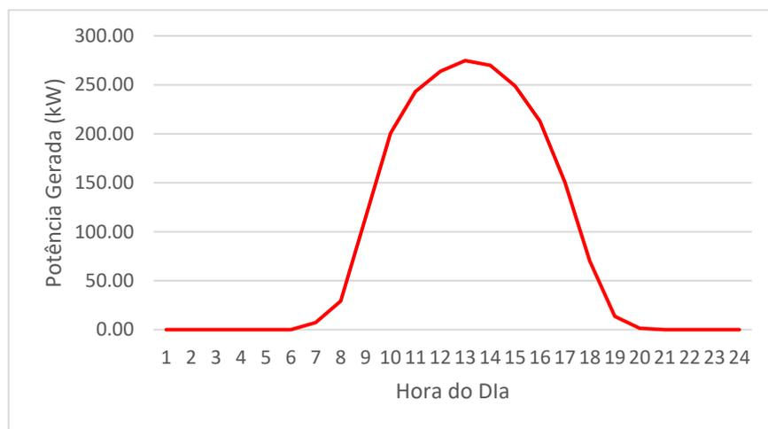
Fig. 2. 9 - Geração do Sistema PV a 20% de penetração na UNIFEI- Itajubá [Autor].
