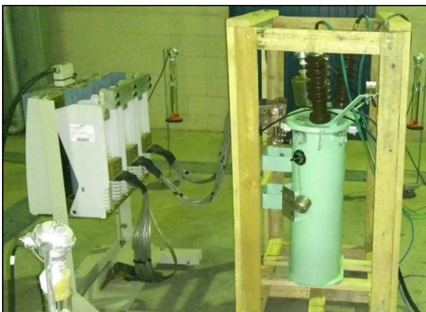
Figura 41 – Ensaio de elevação de temperatura. Fonte: autor.
