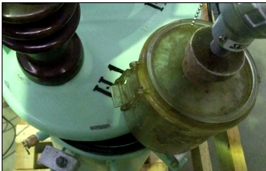
Figura 36 – Medição de temperatura do topo do óleo no ensaio de medição de resistência. Fonte: autor.
