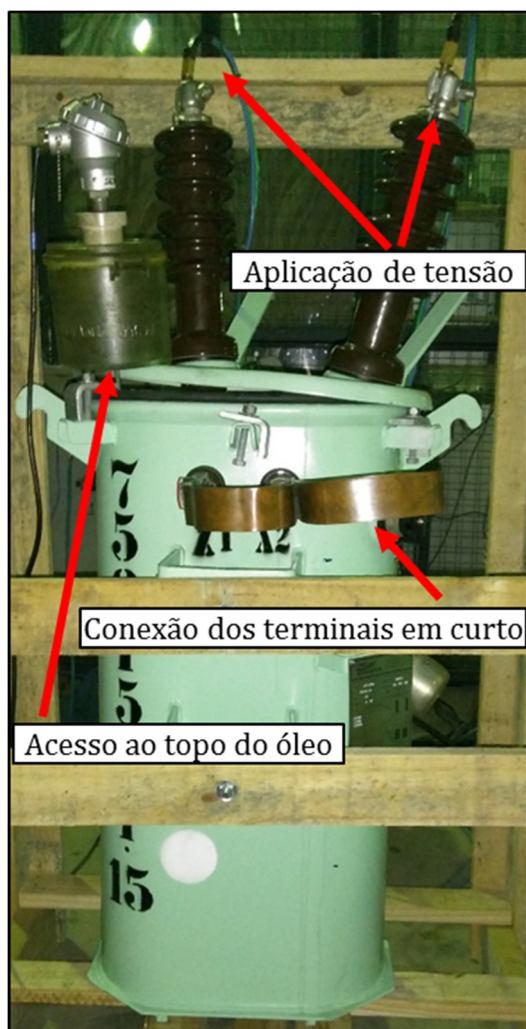
Figura 39 – Conexões do ensaio em curto-circuito. Fonte: autor.
