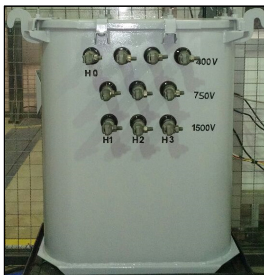
Figura 32 – Transformador elevador utilizados nos ensaios em vazio, ensaio em curto-circuito e elevação de temperatura. Fonte: autor.
