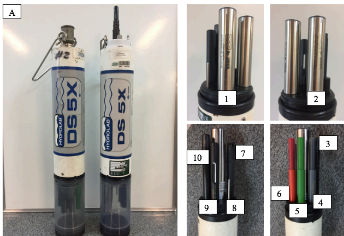
Figura 8: Sondas HACH DS5X utilizadas no campo para obter medidas em tempo real (A): sensor de clorofila ( \mu\text{g/L} ) (1); sensor de Cyanobacteria para leitura Ficocianina (milivolts) (2); turbidez (NTU), (3); amônia ( \text{mg N/L} ) (4); potencial redox ( \text{mV} ) (5); nitrato \text{mg N/L} (6); pH (7); temperatura ^{\circ}\text{C} (8); condutividade elétrica ( \mu\text{S/cm} ), (9); oxigênio dissolvido ( \text{mg/L} ) (10).
