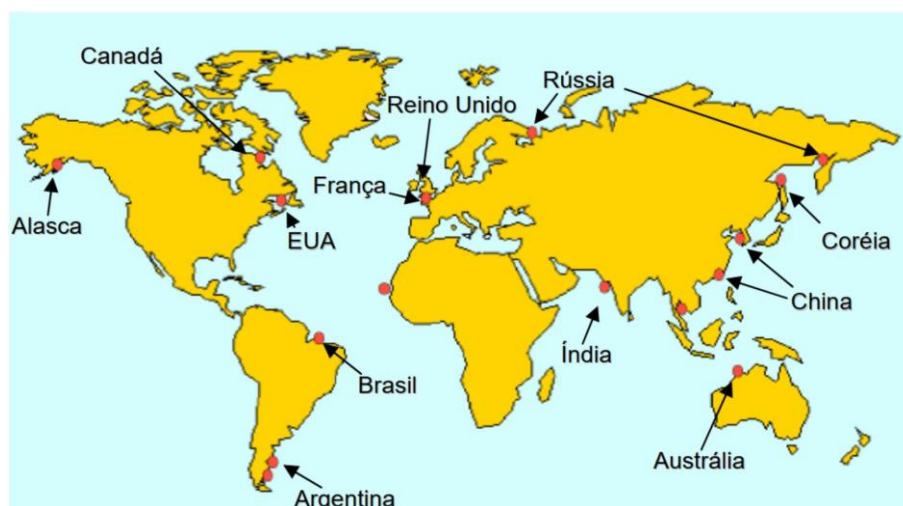
Figura 2.3 – Lugares apropriados para a instalação de usinas maremotriz.
