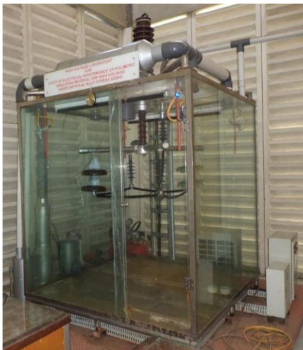
Figura 25 – Exemplo de câmara para ensaio com solicitações múltiplas de 5000 horas [165].
