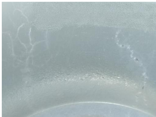
Figura 44 – Erosão na amostra do fabricante X retirada após o ciclo de 3000 horas.
