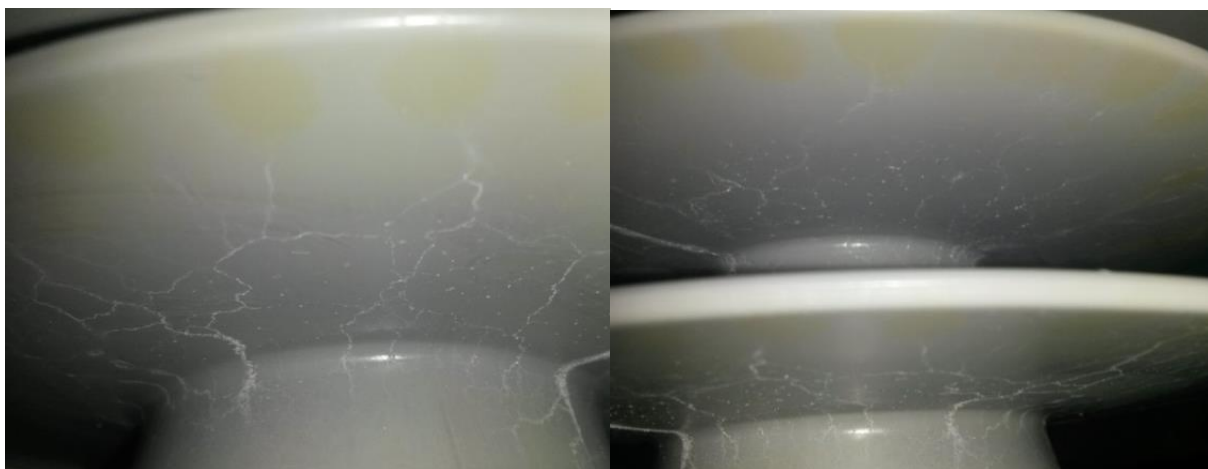
Figura 40 – Detalhes do acúmulo de água e erosões na amostra do fabricante Y com 7500 horas de envelhecimento
