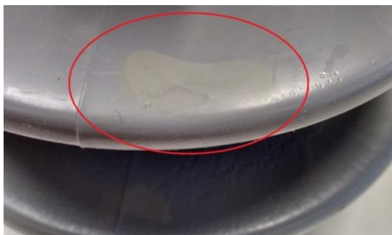
Figura 48 – Marca sugestiva de acúmulo de água na amostra de 1500 horas do fabricante W
