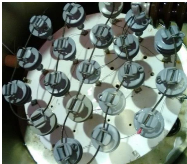
Figura 34 – Interior da câmara com as amostras após envelhecimento de 3500 horas
