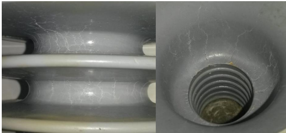
Figura 55 – Detalhes das erosões na amostra do fabricante Z com 7500 horas de envelhecimento
