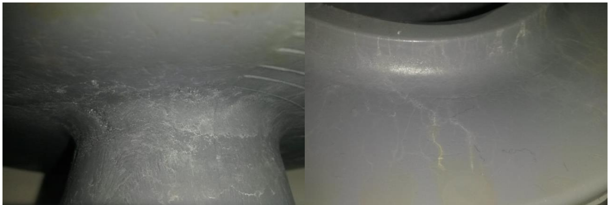
Figura 46 – Erosões na superfície da amostra do fabricante X após 7500 horas.
