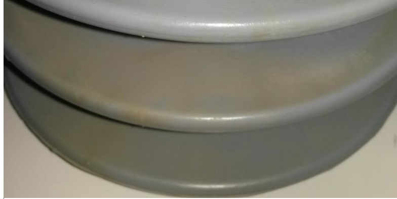
Figura 45 – Amarelecimento da amostra do fabricante X com 7500 horas de envelhecimento
