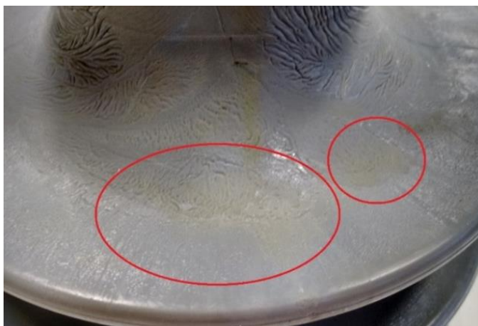
Figura 42 – Amostra de 1500 horas com marcas de acúmulo de água com amarelecimento
