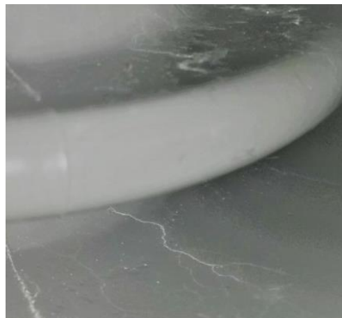
Figura 51 – Erosões na amostra de 7500 horas de envelhecimento do fabricante W
