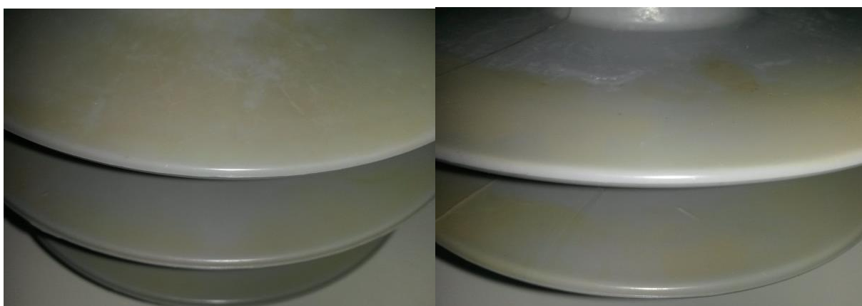
Figura 39 – Amarelecimento da superfície da amostra do fabricante Y com 7500 horas
