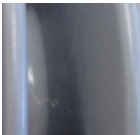
Figura 53 – Amostra do fabricante Z após o ciclo de 3500 horas com sinais de erosão
