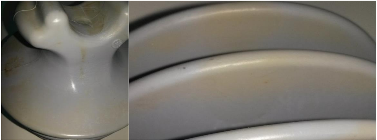
Figura 54 – Amarelecimento da superfície da amostra do fabricante Z com 7500 horas
