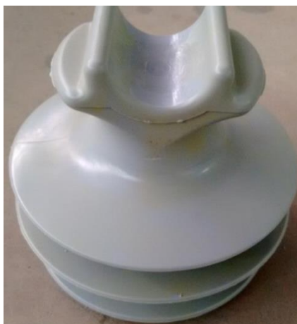
Figura 36 – Amostra do fabricante Y após 500 horas de ensaio
