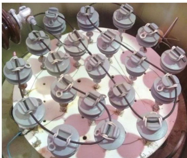
Figura 35 – Interior da câmara com as amostras após envelhecimento de 7500 horas
