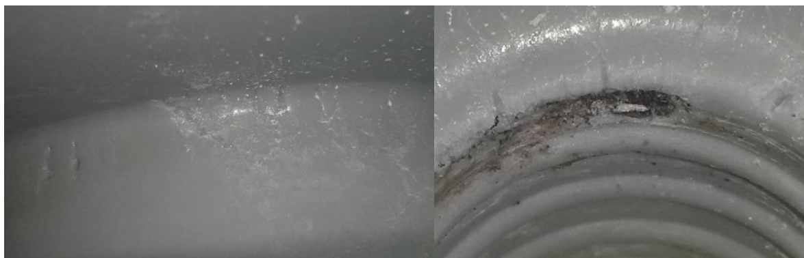
Figura 41 – Detalhes do processo de erosão na amostra de 7500 horas (a) externa, (b) interna.
