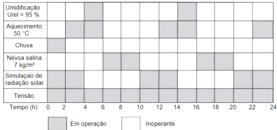
Figura 26 – Ciclo de 24 horas com duração das solicitações às quais as amostras são submetidas.
