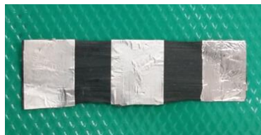
Figura 26 – Proteção de alumínio utilizada em amostra de pré-impregnado sujeita à análise DMA da reação de cura.
