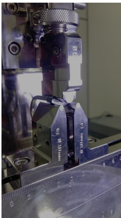
Figura 39 – Dispositivo de ensaio utilizado na determinação da resistência ao cisalhamento interlaminar do compósito fabricado a partir de prepregs com diferentes tempos de envelhecimento.
