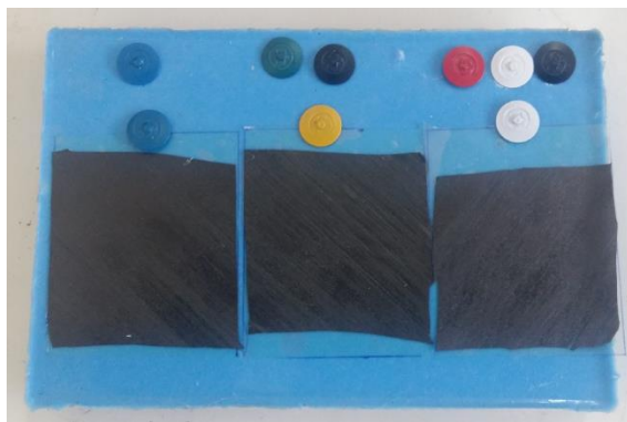
Figura 88 – Montagem utilizada para medida da concentração de voláteis: amostras de pré-impregnados depositadas sobre proteções plásticas e fixadas em molde de silicone com percevejos.
