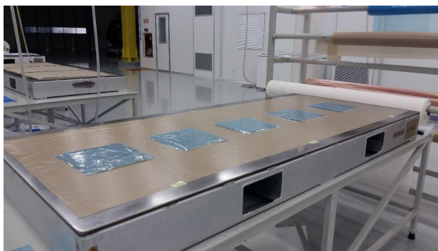
Figura 32 – Segunda etapa da laminação dos compósitos: inserção de outra camada de teflon poroso e uma camada de filme desmoldante azul sobre os laminados.
