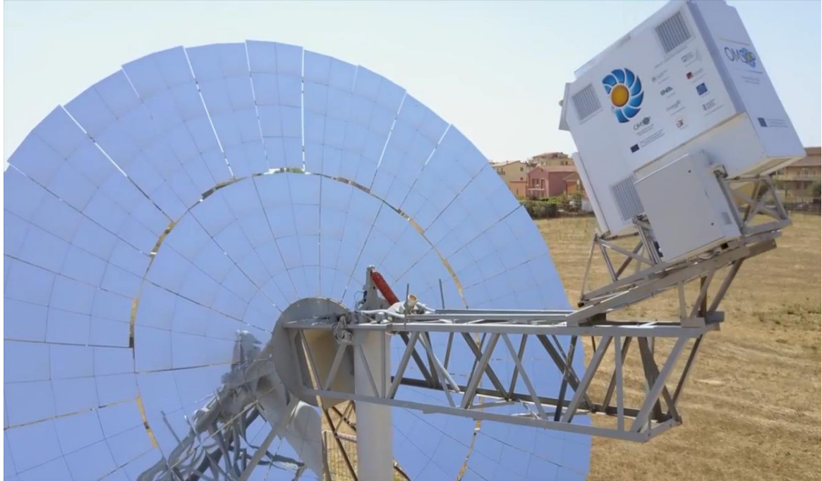
Figura 2.23 - Projeto OMSoP: Instalação do receptor/microturbina no foco do concentrador parabólico (ETN, 2019).
