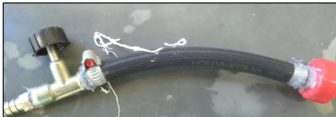
Figura 12 - Sistema completo de saída e coleta do biogás
