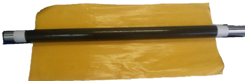
Figura 3.24 – Retirada do filme de proteção na última camada de pré-impregnado.
