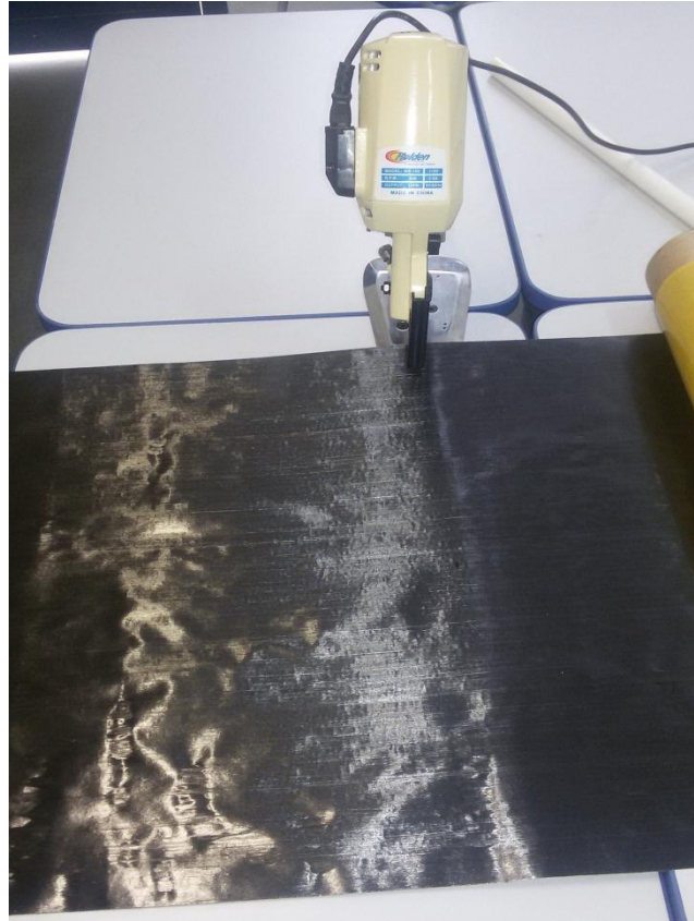
Figura 3.20 – Corte do tecido pré-impregnado de acordo com sequência de empilhamento otimizada.
