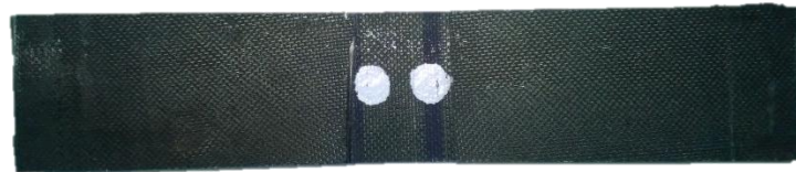
Figura 3.14 - Preparação do corpo-de-prova para compressão com as marcas de tinta branca longitudinais para análise por vídeo extensômetro.
