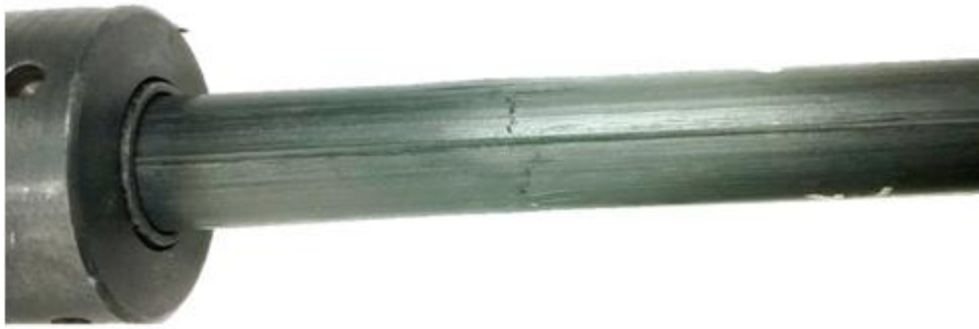
Figura 4.15 – Análise de falha no tubo 7, em carregamento estático de compressão após fadiga.
