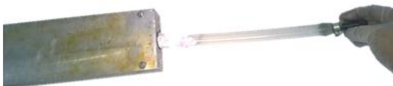
Figura 3.25 – Introdução do bladder , com válvulas, no interior do molde.
