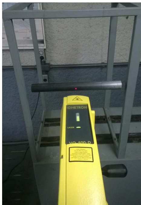
Figura 3.32 – Montagem do ensaio de vibração sem engaste.
