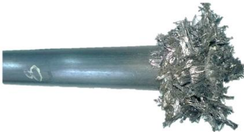
Figura 4.16 - Análise de falha no tubo 8, em carregamento estático de compressão após fadiga.
