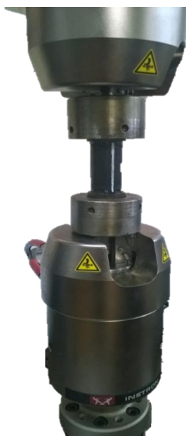
Figura 3.30 – Montagem de amostra do tubo para ensaio de torção
