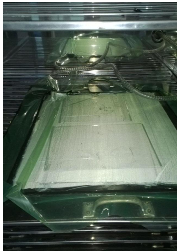
Figura 3.6 – Laminado sendo processado com bolsa de vácuo dentro da estufa.
