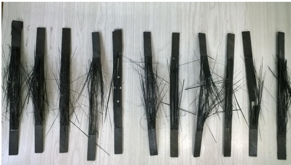
Figura D2 – Corpos-de-provas após ensaios de tração na direção longitudinal (0°) do laminado
