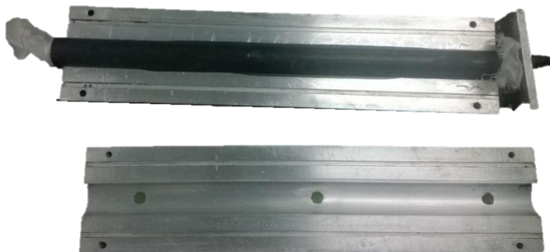
Figura 3.28 – Abertura do molde após cura do composto.
