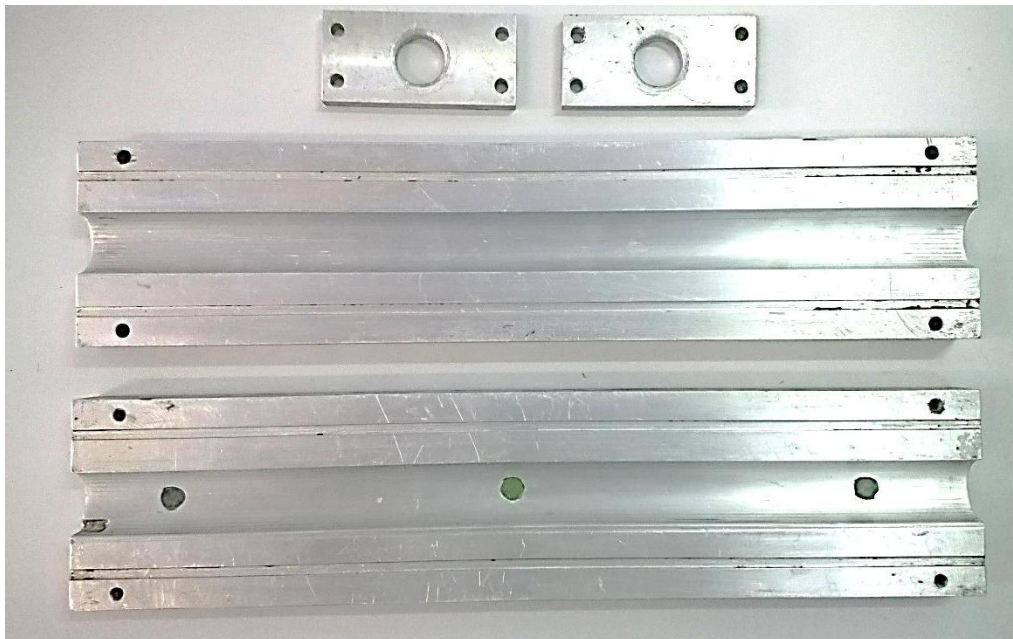
Figura 3.4 – Molde acabado com as laterais de fechamento.
