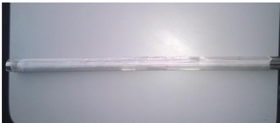
Figura 3.23 – Tecido desmoldante aplicado ao bastão de laminação.
