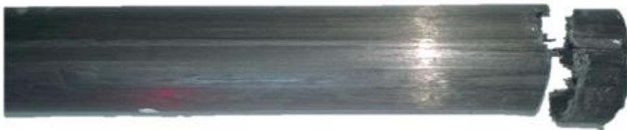
Figura 4.17 - Análise de falha no tubo 10, em carregamento estático de compressão após fadiga.
