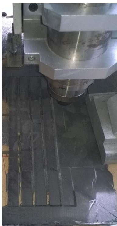
Figura 3.8 – Placa para ensaio de tração à 0° sendo cortada em corpos-de-prova nas dimensões especificadas.
