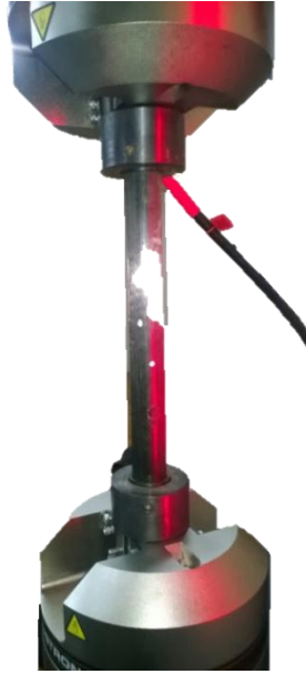
Figura 3.31 – Preparação da amostra para ensaio de compressão estático.
