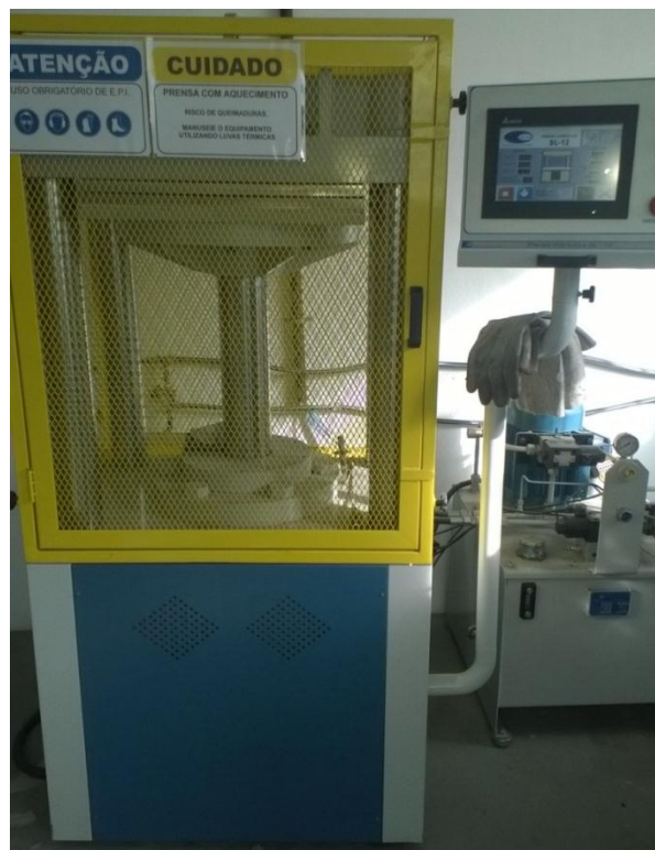
Figura 3.7 – Máquina de compressão em processo de cura dos tabs.
