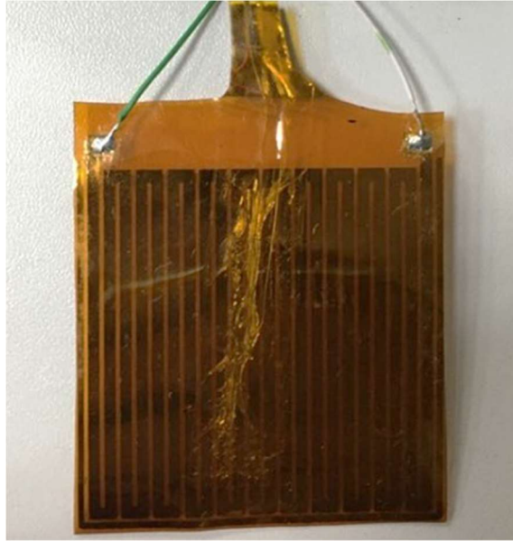
Figura 4.2 – Aquecedor resistivo utilizado para a imposição do fluxo de calor.
