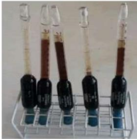
Figura 10- Butirômetro de Gerber ilustrando a determinação do teor de gordura do leite UHT pelo método químico. Fonte: Autor.
