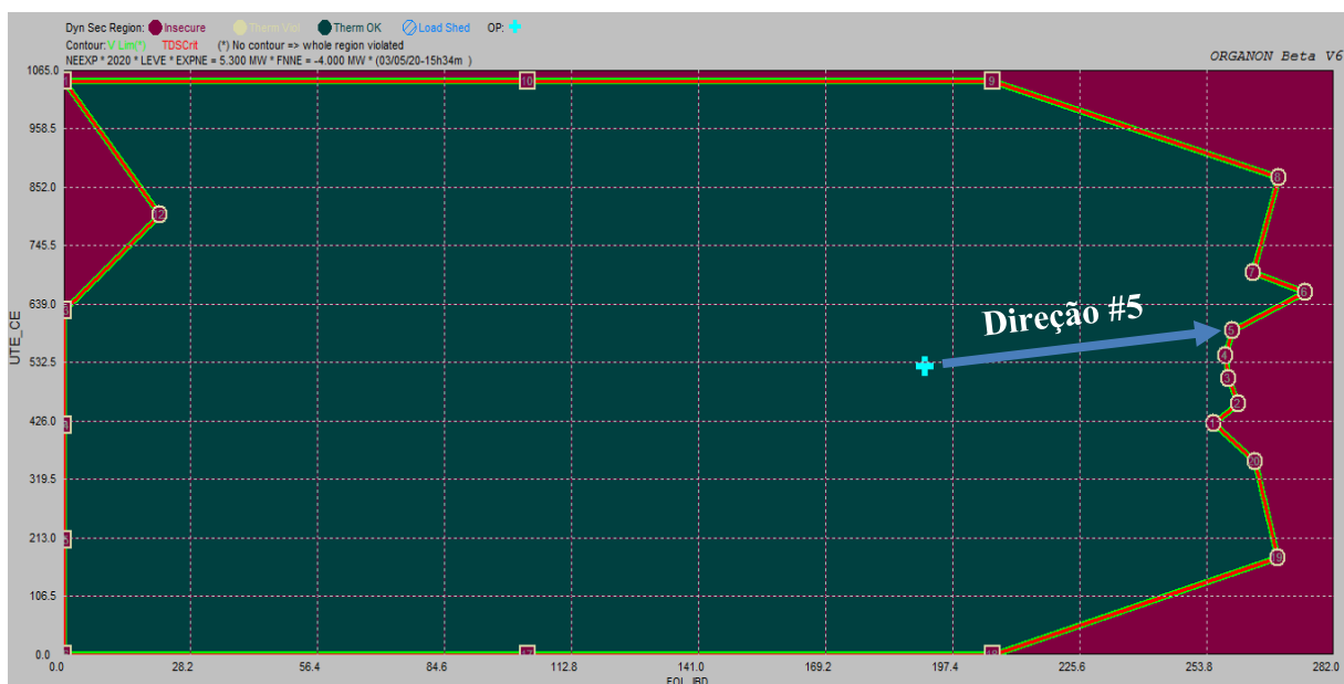
Figura 7.39: RSD da Área 2-NE_Exp_carga leve – modo potência reativa.
