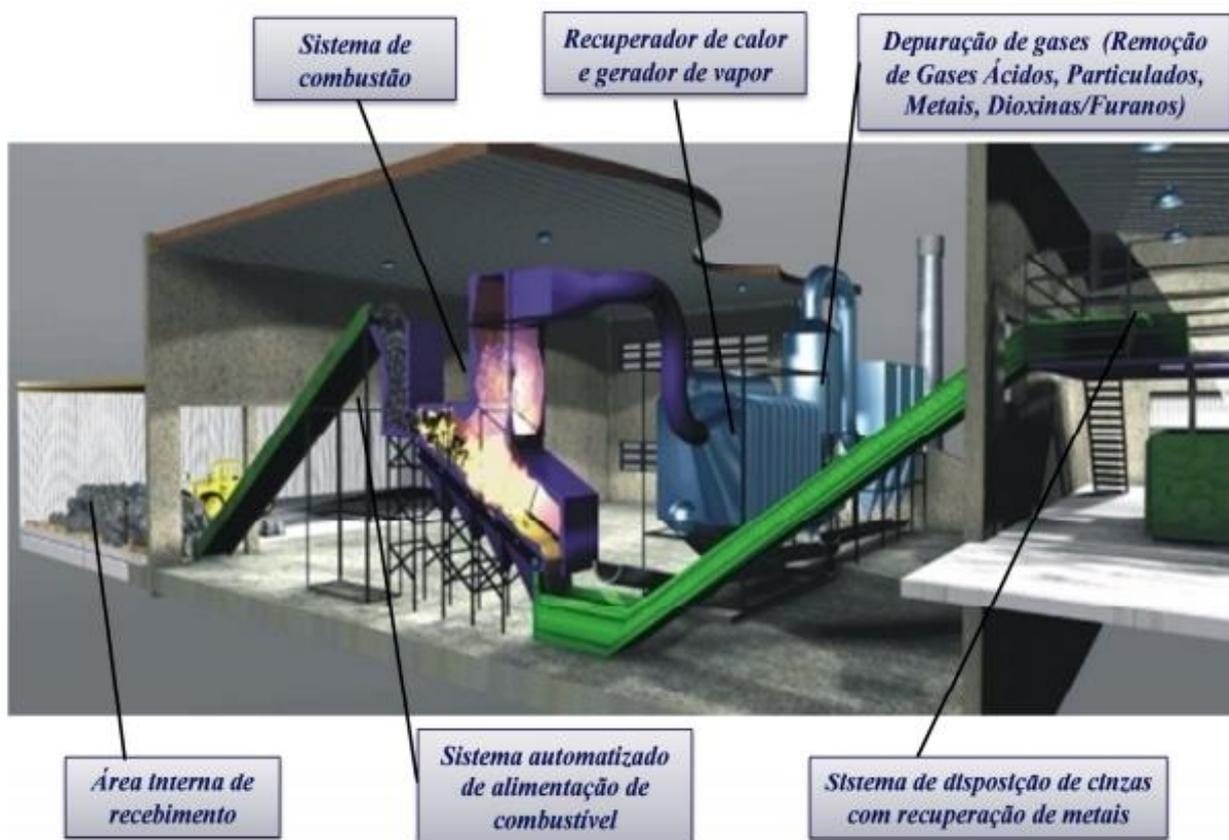
Figura 2.8: Processo de incineração de RSU. Fonte: EPE (2014a).
