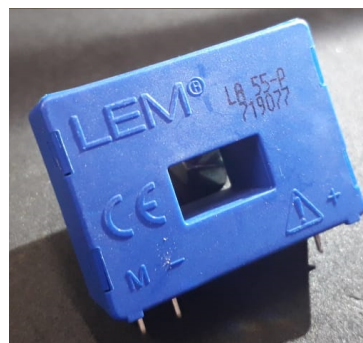
Figura 36 – Transdutor de corrente por efeito Hall LA 55-P/SP1
