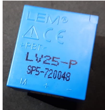
Figura 38 – Transdutores de tensão por efeito Hall LV 25-P/SP5
