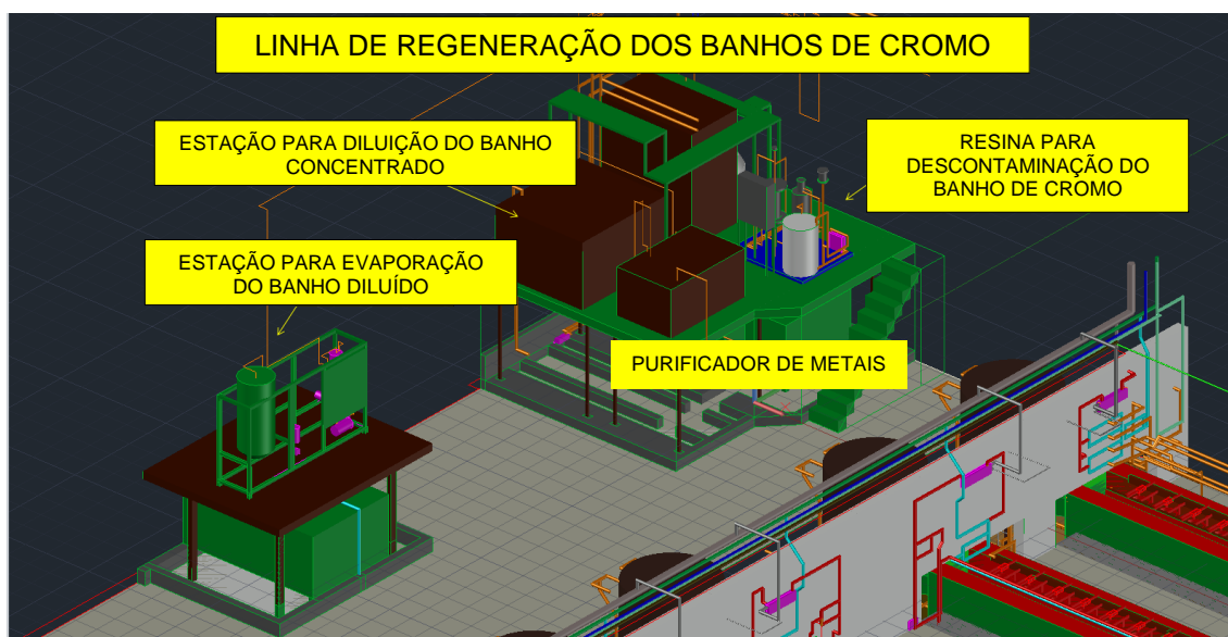
Figura 13 – Representação do fluxo de processo da cromação, denominado “Linha de regeneração dos banhos de cromo”, gerado no software Autocad® Mechanical 2018. Fonte: Autoria própria (2020)
