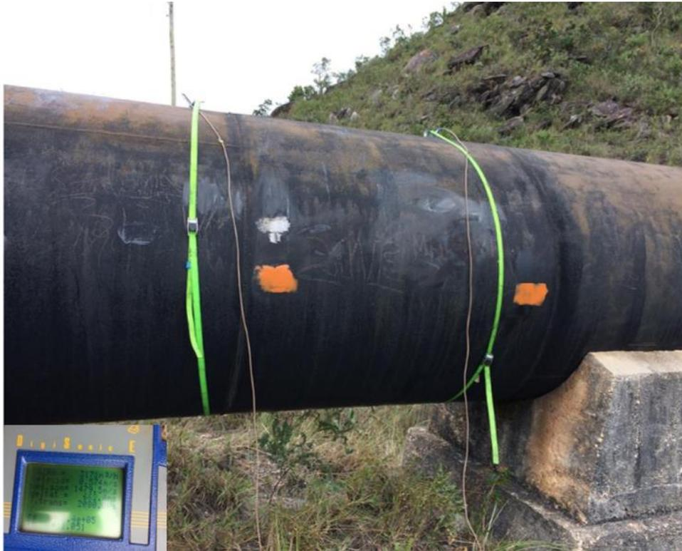
Figura 18 – Detalhe da instalação do medidor ultrassônico e do display do equipamento
