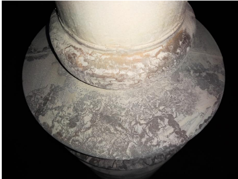
Figura 38 – Consequência do ensaio sobre a camada de contaminação. Fonte: Próprio autor
