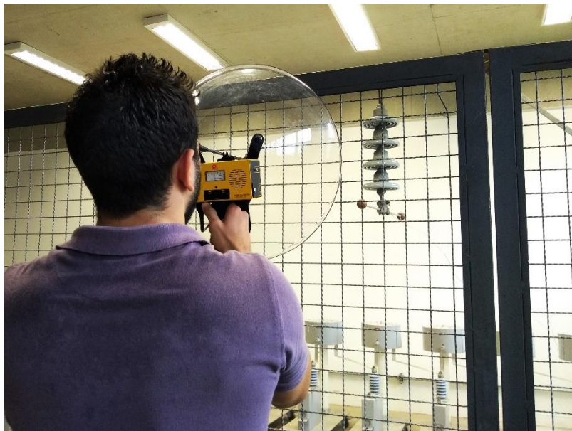
Figura 14 – Cadeia de isoladores sendo inspecionada em laboratório por meio do equipamento Model 250 . Fonte: Próprio autor
