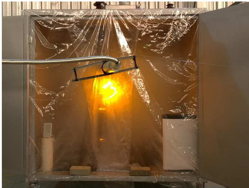
Figura 37 – Arco voltaico sobre o corpo de prova. Fonte: Capelini (2020) 12
