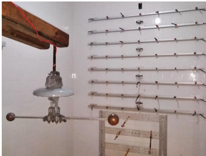
Figura 26 – Amostra de isolador após ensaio de chuva dentro da câmara de ensaio. Fonte: Próprio autor
