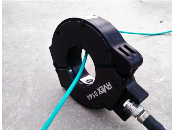
Figura 15 – Equipamento HFCT100 com o condutor de aterramento passando através da sua janela. Fonte: Próprio autor
