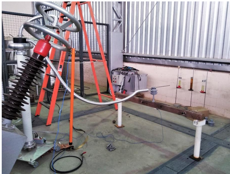
Figura 22 – Circuito de ensaio utilizado.
