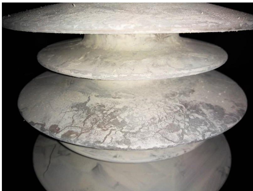
Figura 39 – Consequência do ensaio sobre a camada de contaminação. Fonte: Próprio autor
