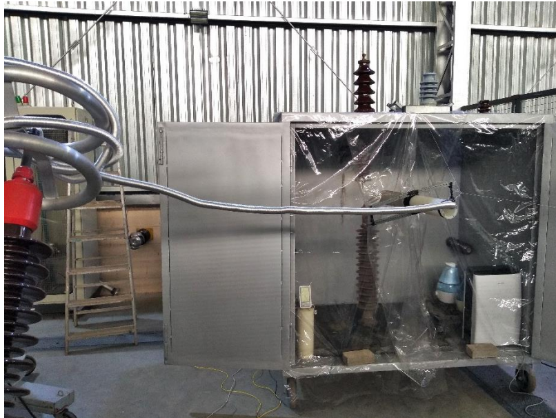
Figura 34 – Configuração final da câmara de ensaio com o tubo de náilon. Fonte: Próprio autor
