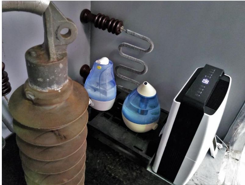
Figura 33 – Interior da câmara de ensaio, mostrando os nebulizadores e o desumidificador.
