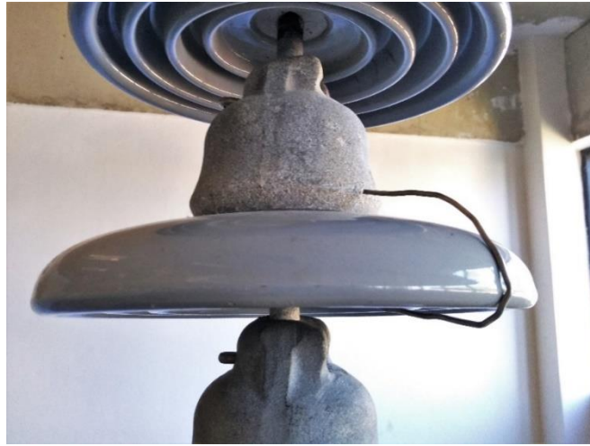
Figura 23 – Método de simulação de descargas por meio de centelhador. Fonte: Próprio autor
