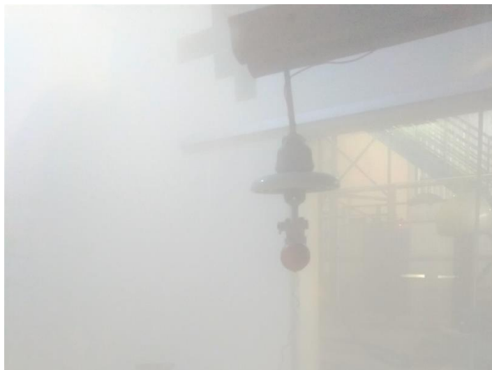
Figura 27 – Amostra de isolador sob névoa salina dentro da câmara de ensaio. Fonte: Próprio autor
