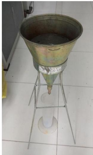
**Figura 22:** Aparelhagem utilizada (conjunto funil, proveta e suporte)
