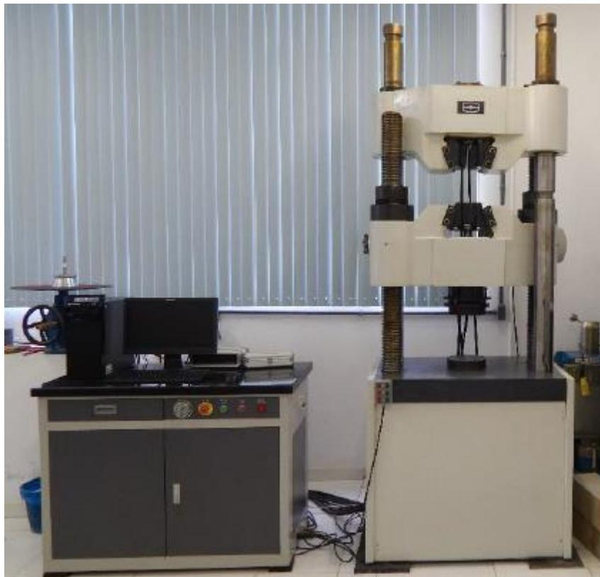
**Figura 28:** Vista da Máquina Time Testing Machines® WAW-1000 C utilizada nos ensaios de resistência mecânica à compressão
