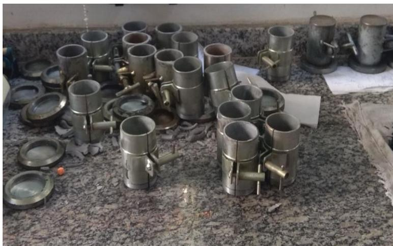
**Figura 25:** Moldes utilizados para confecção dos corpos de prova
