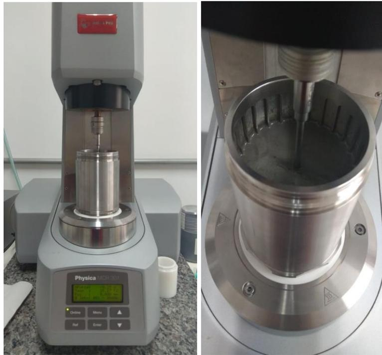
**Figura 23:** Reômetro Anton Paar Physica MCR-301 à esquerda e copo do reômetro com sua grade à direita
