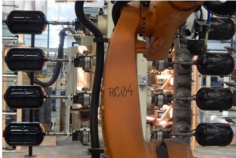
Figura 13- Máquina de enrolamento filamental com quatro eixos de enrolamento
