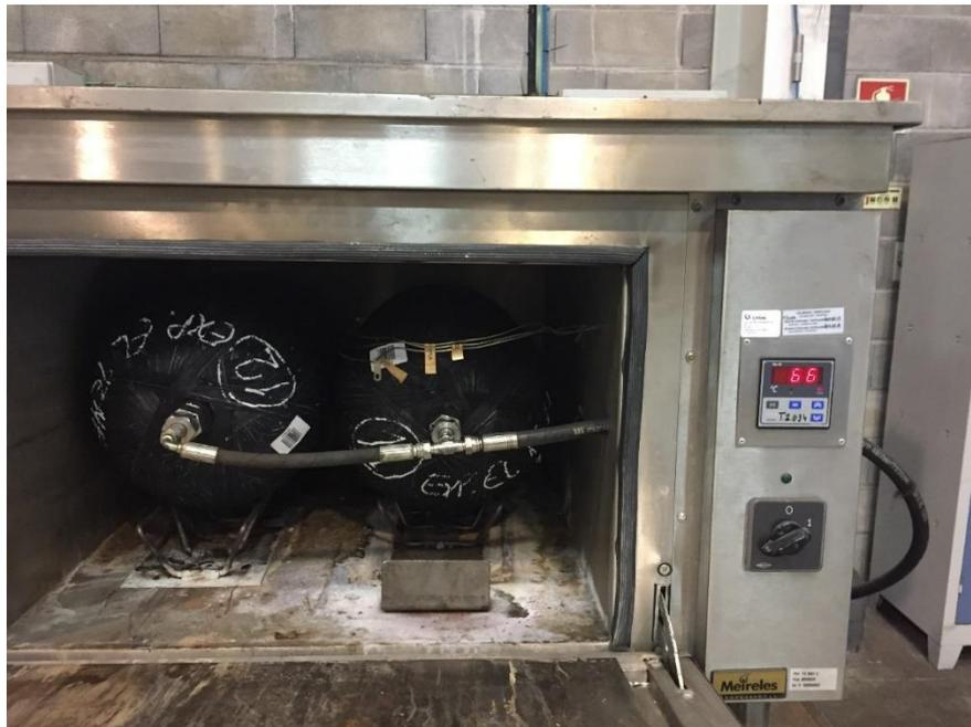
Figura 15- Recipientes internos submetidos ao teste de pressão cíclica a temperaturas extremas
