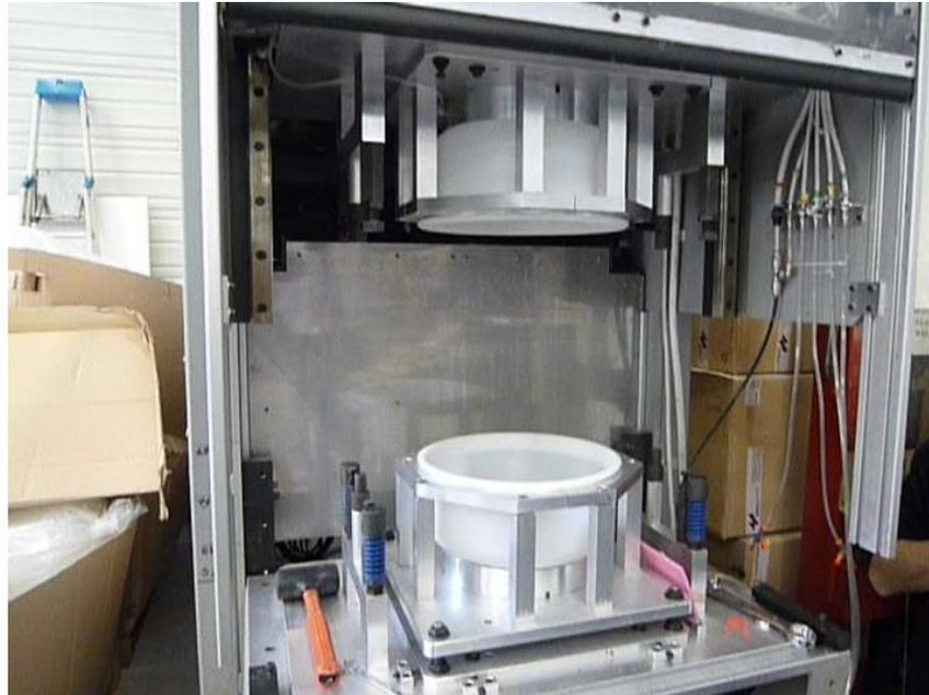
Figura 12- Máquina de soldagem plástica com as duas partes do recipiente interno
