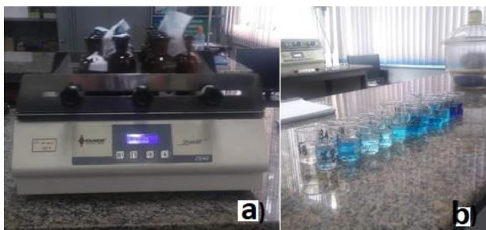
Figura A.4 - a) Agitador de Azul de Metileno (12 h); b) Sequência de cores pós adsorção de azul de metileno.
