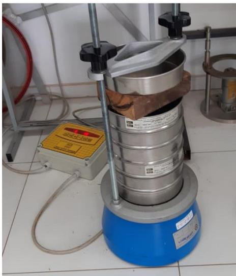
Figura 3.5 - Agitador eletromagnético de peneiras
