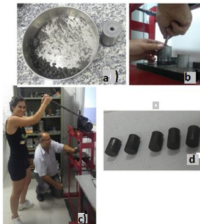
Figura A.3 - a) Confeção dos *pellets*; b) Formação do corpo de prova; c) Compressão do corpo de prova e; d) Corpo de prova.
