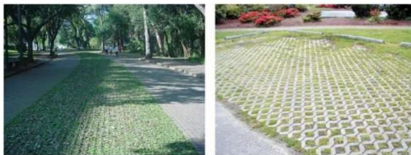
Figura 2.1 – Exemplos de Pavimentos Porosos
