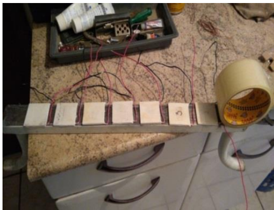
Figura 41 – Montagem do núcleo termogerador
