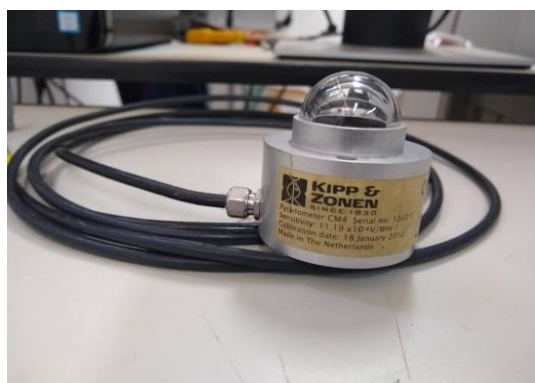
Figura 48 – Piranômetro Kipp e Zonen CM4
