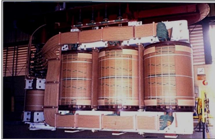
Figura 3-5 - Bobinas de cobre – transformador trifásico
