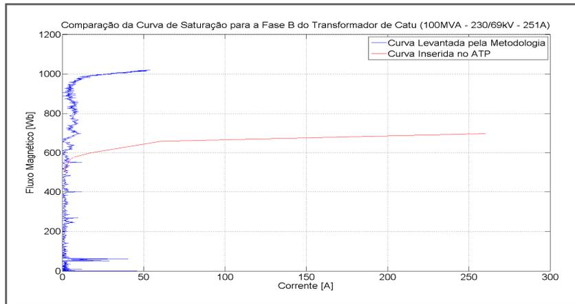
Figura 6-24– Curva de Saturação para a Energização do Transformador de CTU – fase B
