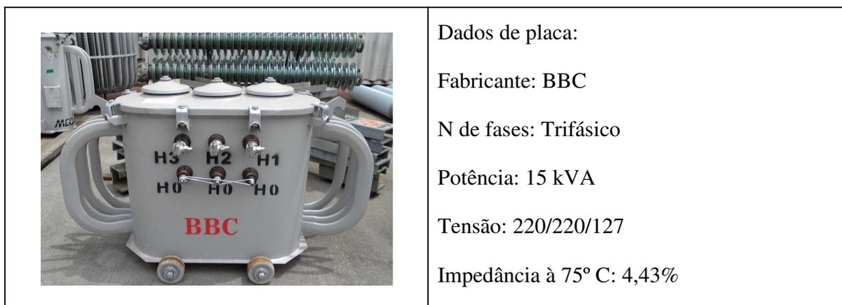
Figura 4-17– Transformador utilizado nos ensaio de laboratório.
