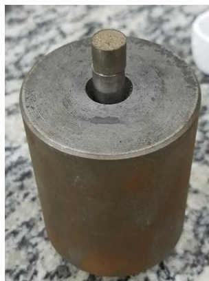
Figura 21 – Pastilha formada a partir da prensa uniaxial.
