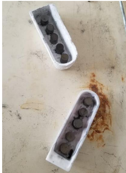
Figura 24 – Pastilhas dispostas nos cadinhos de alumina para a sinterização.
