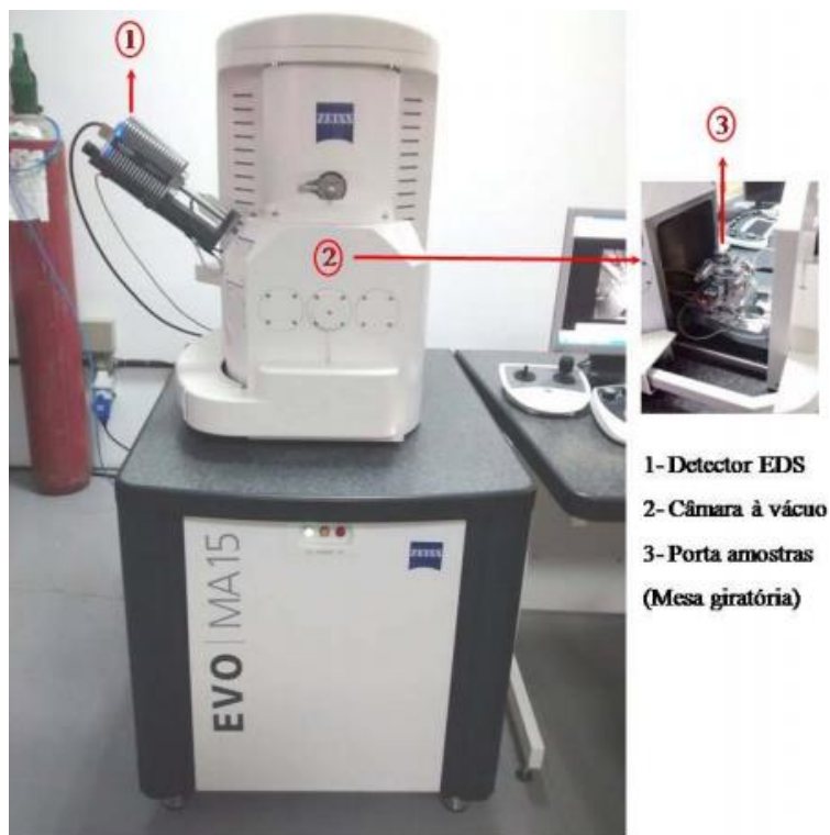
Figura 25 - Microscópio eletrônico de varredura. Marca ZEISS, modelo EVO MA15 localizado no LCE da UNIFEL.
