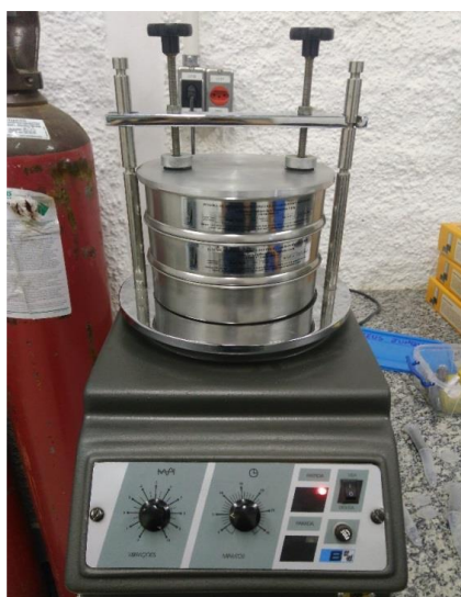
Figura 17 – Agitador de peneiras localizado no LPCM da UNIFEI.
