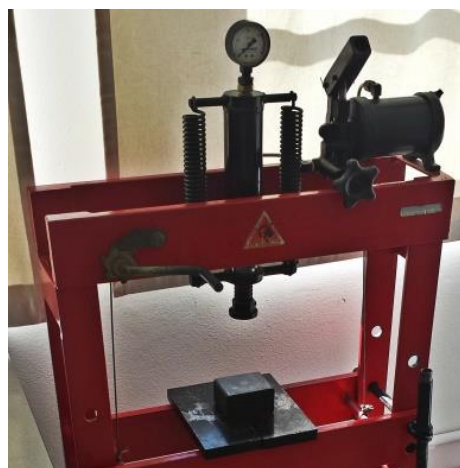
Figura 20 – Prensa uniaxial Schulz localizado no LPCM da UNIFEI.
