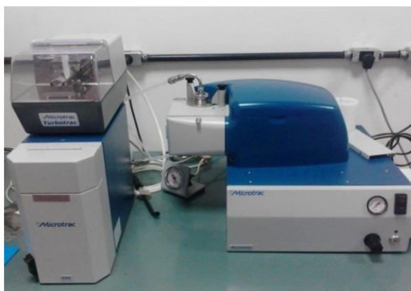
Figura 18 – Analisador de tamanho de partículas localizado no LCE da UNIFEI.
