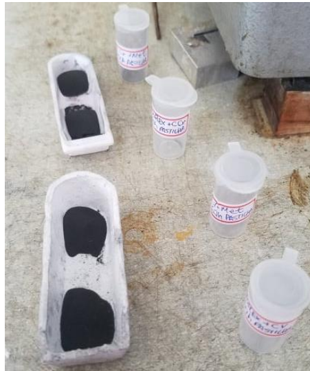
Figura 19 – Pós dispostos nos cadinhos para o tratamento térmico de alívio de tensões
