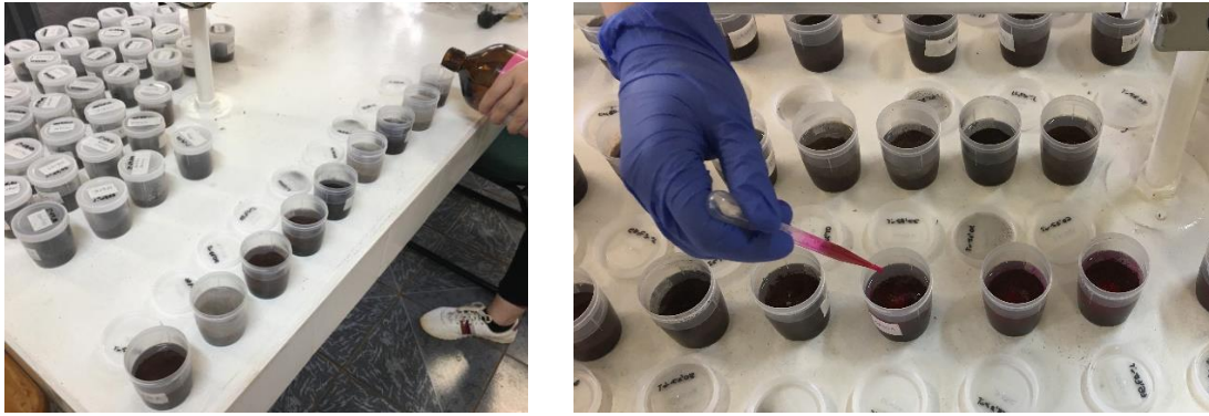
Figura 17 - Finalização do teste com a) Adição de álcool etílico concentrado. b) Adição do corante rosa de bengala
