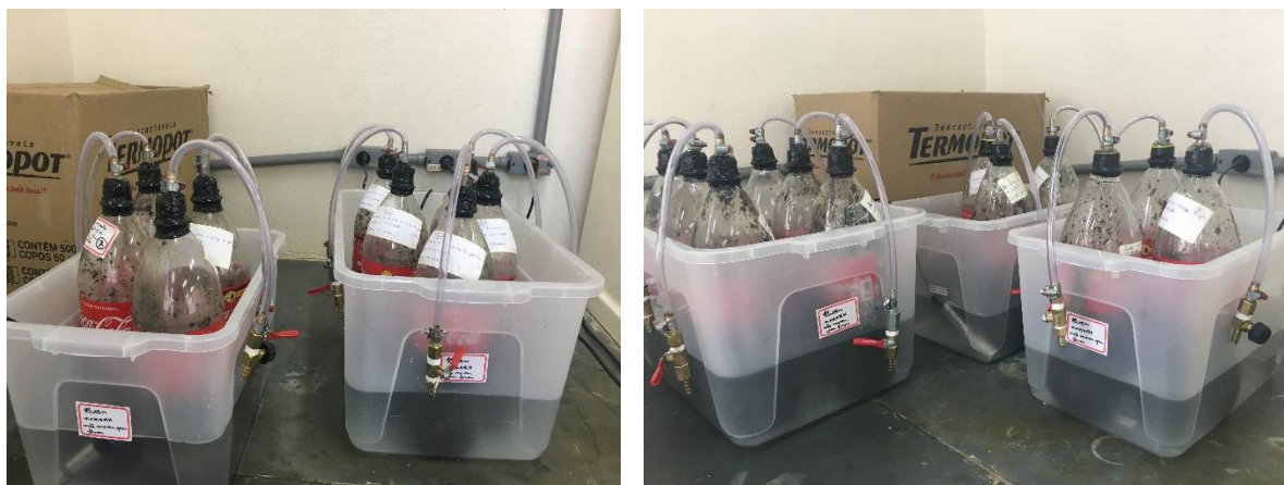
Figura 16 - Digestão anaeróbia em escala experimental dos processos sequenciais.
