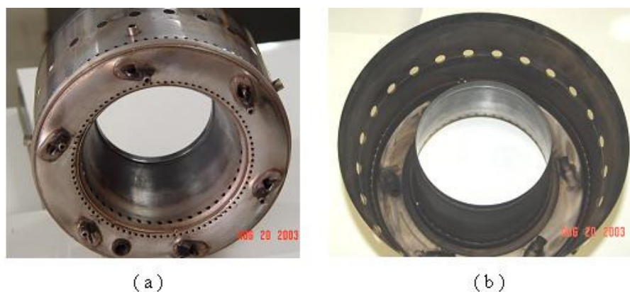
Figura 34- Câmara anular em detalhes.
