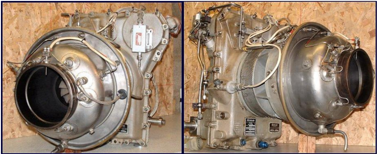
Figura 33- Microturbina, modelo T-62T-32 fabricada pela Solar Turbines.
