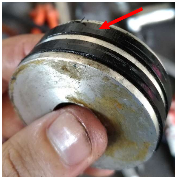
Figura 30 - Anéis de vedação desgastados
