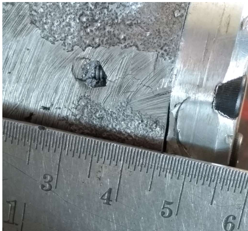
Figura 32 - Dimensão da rachadura no topo da sede de válvula
