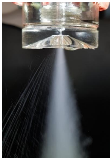
Figura 4. 3 Injetor efervescente elaborado em acrílico
