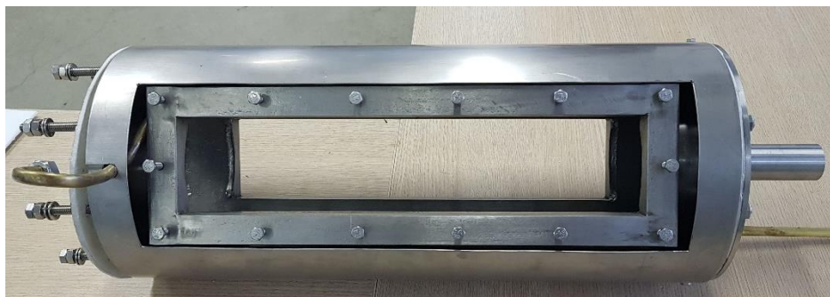
Figura 4. 23 Câmara de combustão montada
