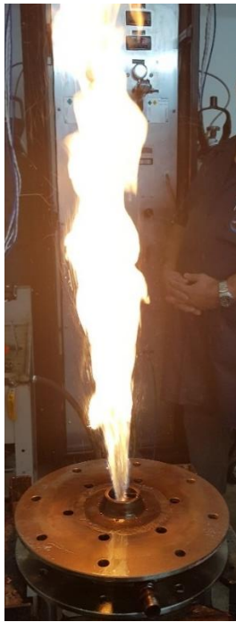
Figura 4. 26 Queima convencional aberta de Diesel-S10
