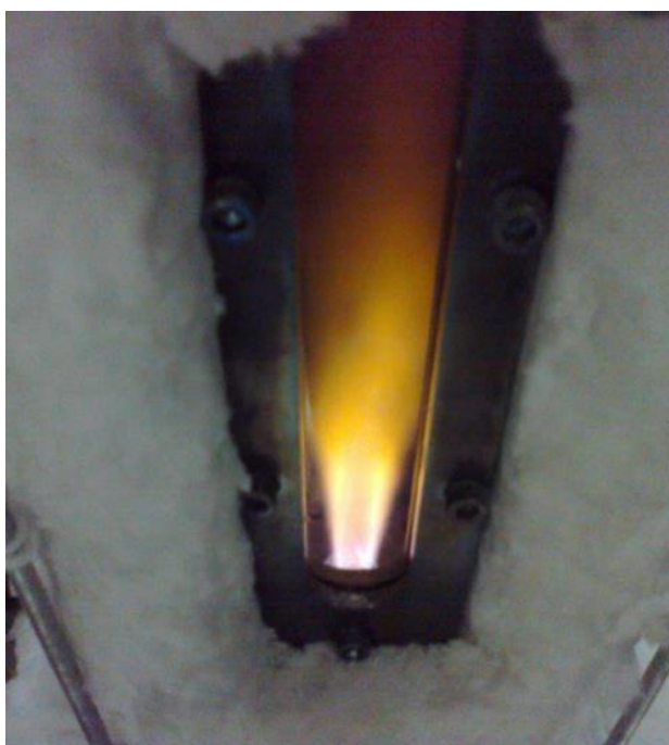
Figura 2.11 Aspecto da chama no início do pré-aquecimento da câmara de combustão.
