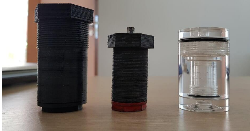
Figura 3. 7 Versões do injetor efervescente desenvolvidas para a câmara de combustão sem chama
