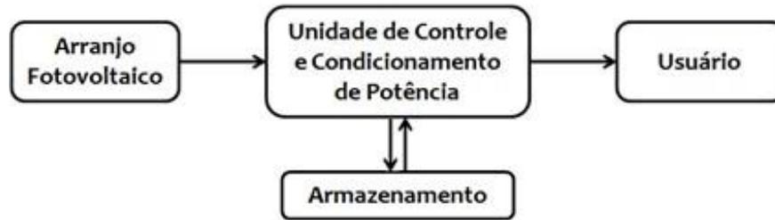
Figura 2.11. Sistema fotovoltaico isolado (CRESESB, 2013).
