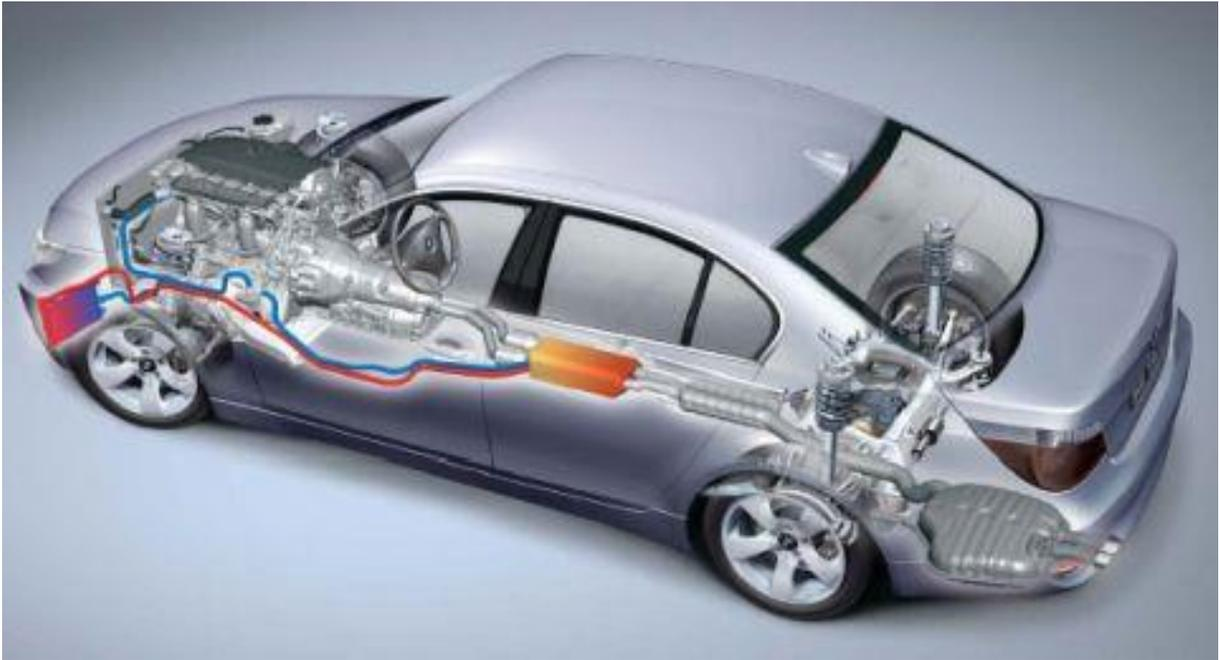
Figura 2.27. Esquema de recuperação da energia nos gases do escape, representando uma melhora no uso do combustível em 15% (WEI et al., 2011).
