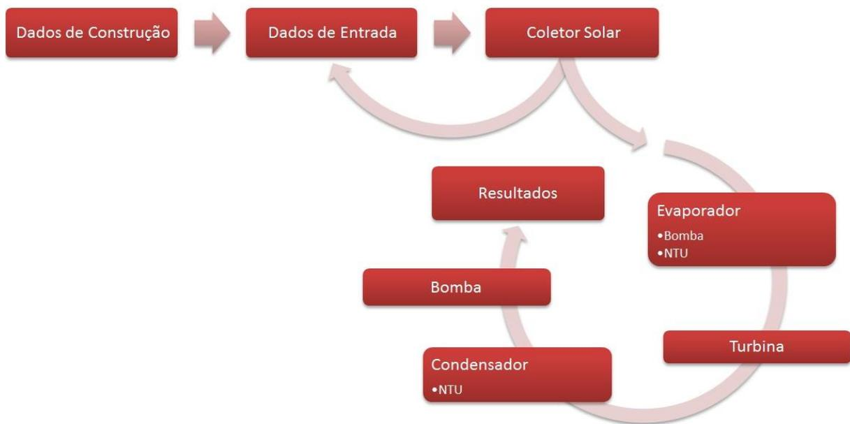
Figura 3.13. Diagrama simplificado de funcionamento do CROSe.
