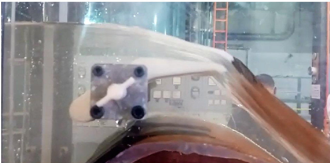
Figura 88 – Ensaio para análise do comportamento do nível a montante em função do ângulo de abertura para a vazão de vertimento de 1,69 [L/s].
