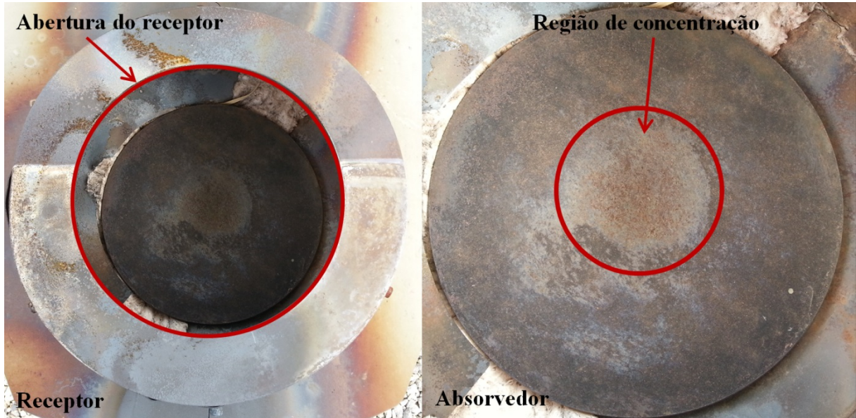
Figura 5.48 - Receptor do sistema Dish Stirling com detalhe da região do absorvedor.
