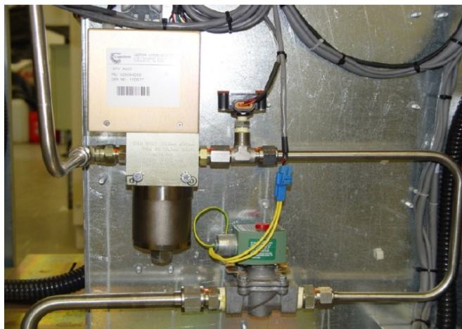
Figura 2.14: Válvula solenoide de controle da vazão (CAPSTONE TURBINE CORPORATION, 2006).
