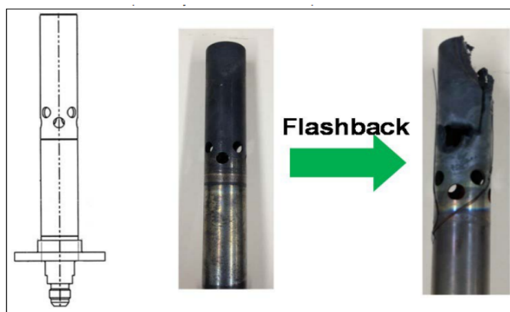
Figura 2.23: Queimador da microturbina Capstone modelo C65 danificado pela ocorrência do flashback (Turns, 2012).
