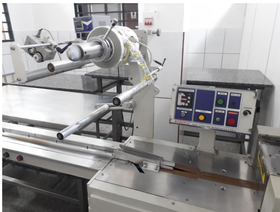
Imagem 21: Máquina de embalar – Fábrica AZ. de pé de moleque
