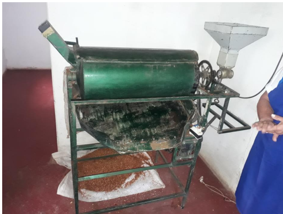
Imagem 26: Despeliculador, ou máquina de limpar – Fábrica A. de pé de moleque
