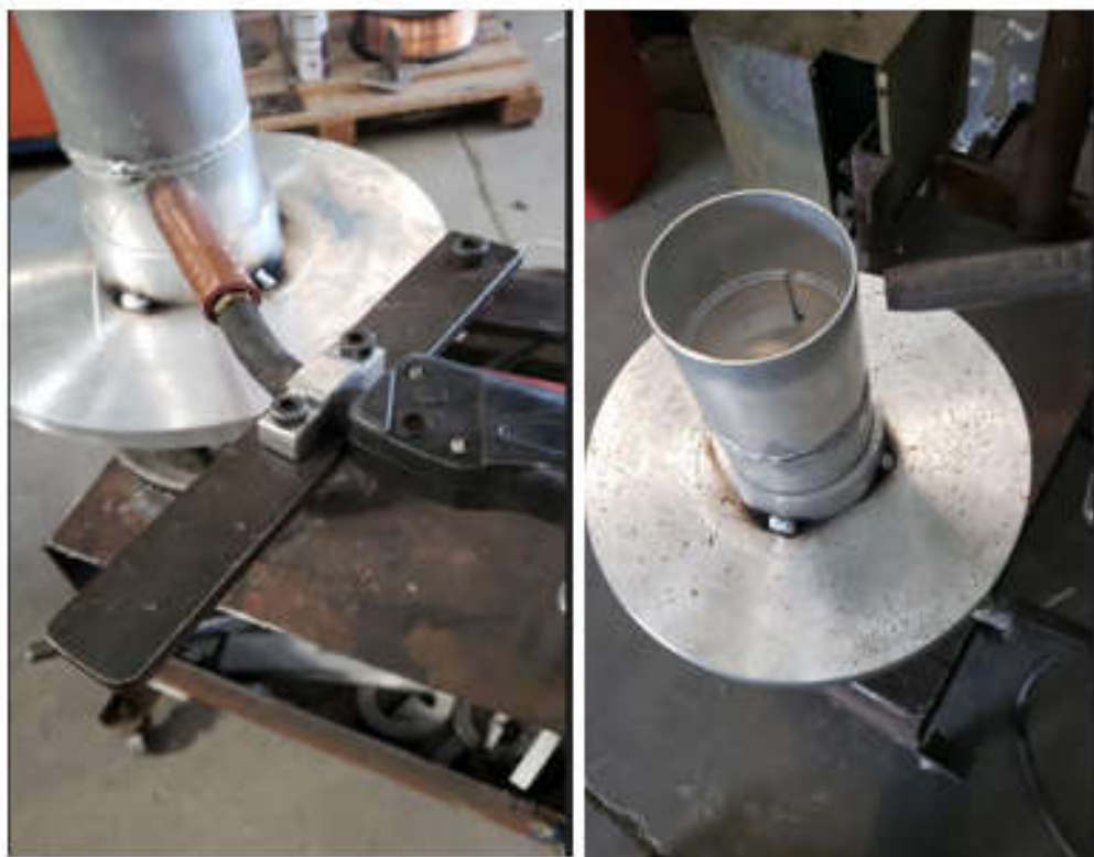
Figura 21 - Sistema semiautomático de solda dos corpos de prova
