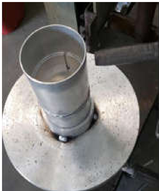
Figura 22 - Vista interna do corpo de prova - peça cilíndrica dentro do tubo Fonte: Autor 2021
