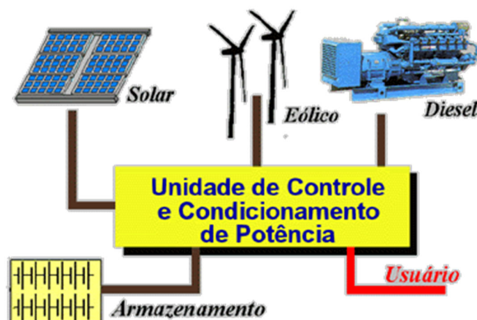
Figura 2.36 - Exemplo de sistema híbrido. Fonte: (CRESESB, 2006)
