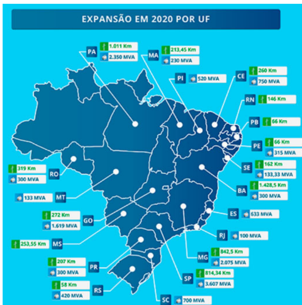
Figura 2.5 - Expansão transmissão e capacidade de transformação 2020
