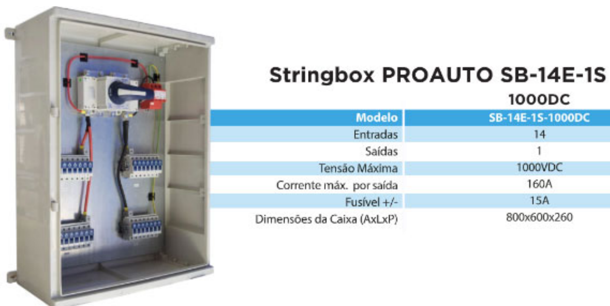
Figura 5.4 - String box PROAUTO SB-14E-1S Fonte: (PROAUTO, 2021)
